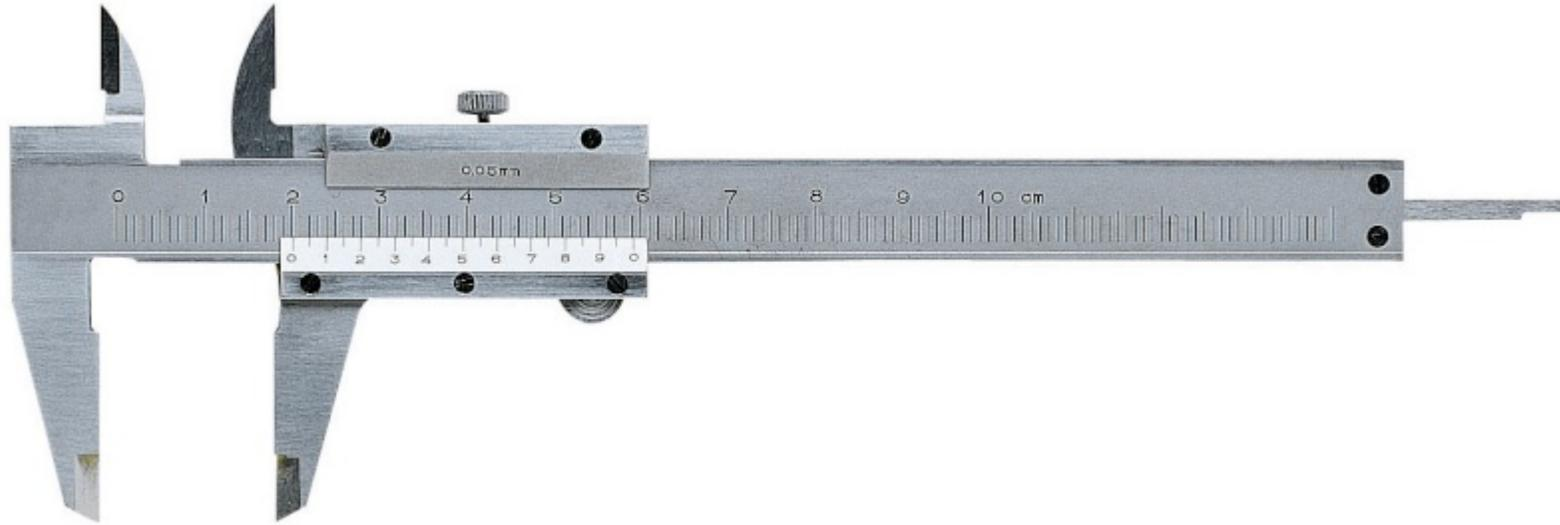
Nel calibri del laboratorio 20 divisioni della scala del nonio  $d$ , corrispondono a 39 divisioni della scala principale  $D$  in millimetri. Ovvero **1 divisione del nonio misura  $39/20$  di mm**, pari a 1.95 mm.
