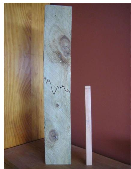
Per tale ragione nei calcoli, si dovrà fare riferimento ad una resistenza di progetto, funzione del valore ricavato dalle prove sperimentali, ma adeguatamente corretto a seconda delle dimensioni del volume.
