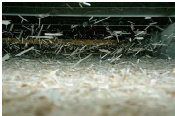
Distribuzione dei trucioli dello strato centrale
