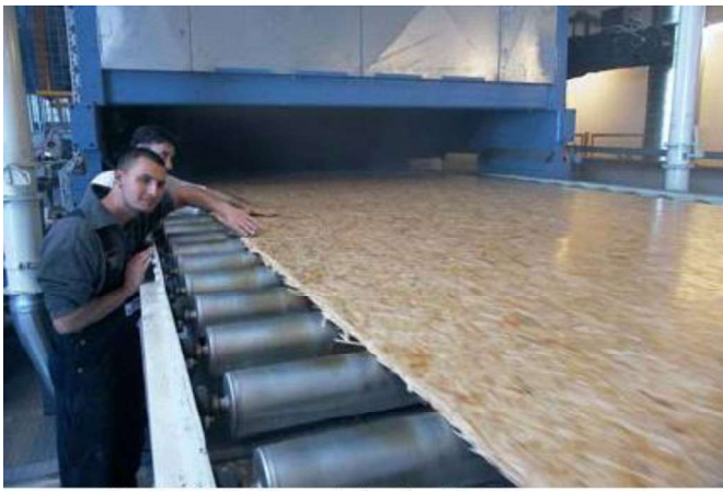
Pannello „ininterrotto“ sui rulli della pressa
