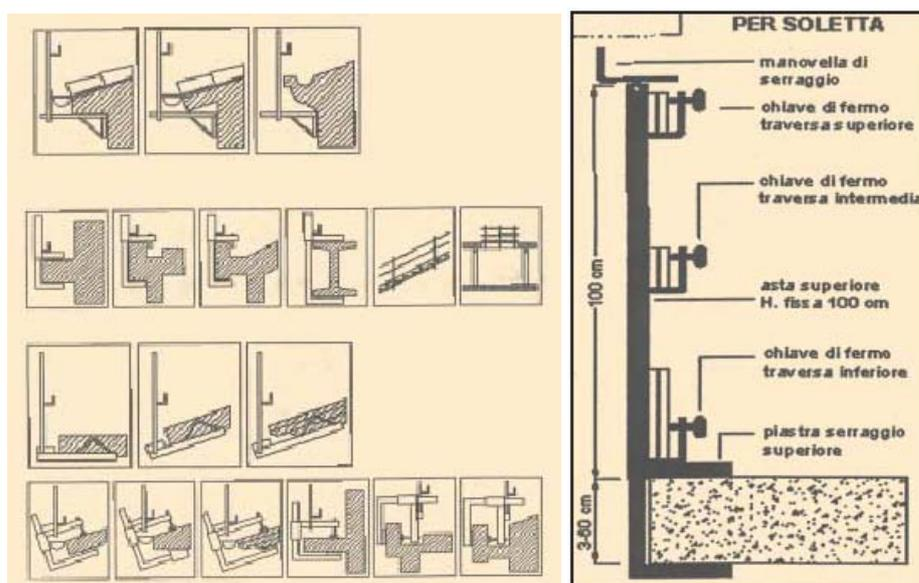
Sono costituiti principalmente da aste metalliche verticali ancorate al supporto con blocco a morsa o tassello, sulle quali vengono montati tre traverse orizzontali.
