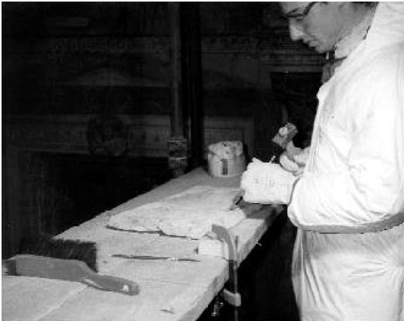
Figura 5 • Pulitura, in laboratorio, di una lastra di marmo. (OPD)
