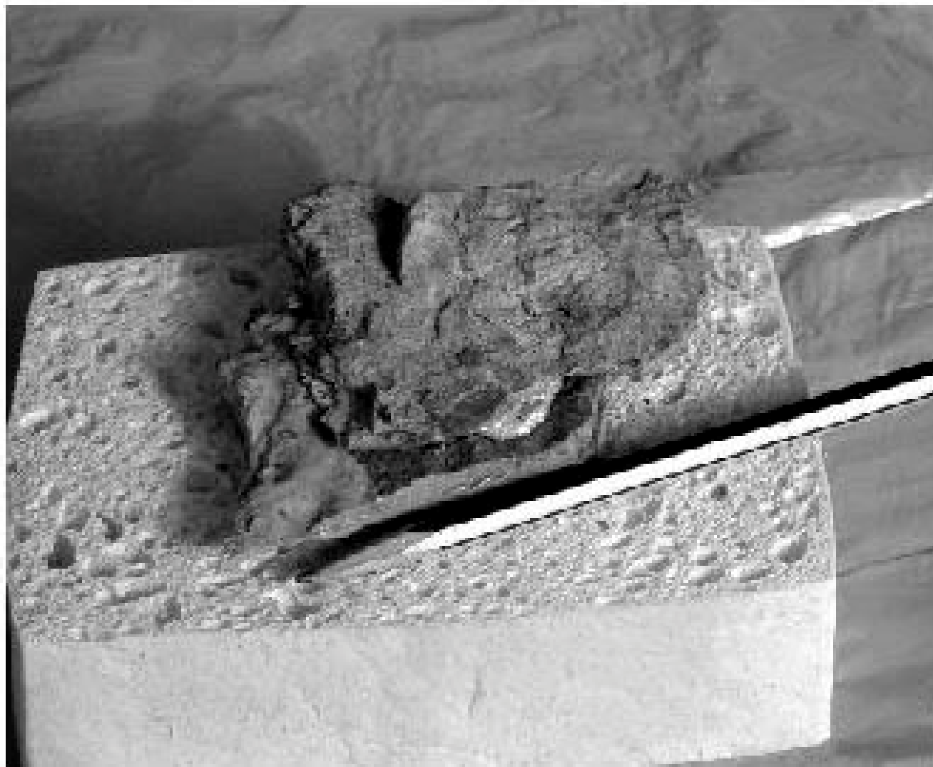
Figura 2 • Le parti vengono avvicinate esercitando una leggera pressione. Durante la fase di indurimento dell'adesivo, può rendersi necessario bloccare provvisoriamente le scaglie o le parti da incollare con vincoli provvisori (ad esempio strisce di carta giapponese o di nastro adesivo, oppure morsetti di legno, per non danneggiare i manufatti) previamente preparati. (ZAM)
