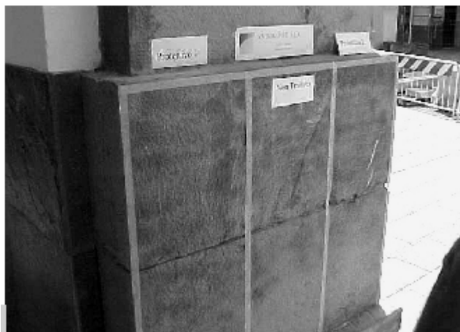
Figura 3 • Provini d'applicazione di due prodotti protettivi su "pietra di promontorio" (calcare marnoso). I prodotti protettivi, una volta asciutti, tendono ad assumere un aspetto trasparente oppure opaco. Poiché tale caratteristica può variare in funzione del prodotto e della superficie sulla quale sarà utilizzato, sono opportuni alcuni saggi d'applicazione. (SAL)
