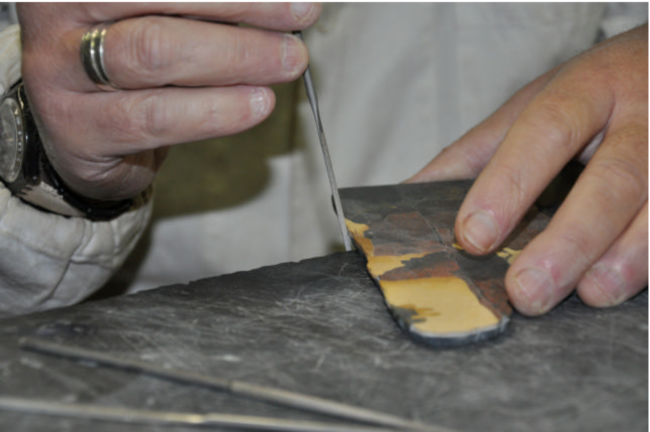
Figura 6 • Rifinitura dei bordi di un pezzo con lima diamantata piatta. Il bordo viene inclinato verso l'interno per favorire l'incastro e creare delle commessure perfette in superficie. (OPD)
