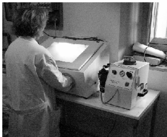
Figura 2 • Operatrice durante l'azione di microsabbatura. La pulitura si svolge in condizioni di sicurezza dai rischi provocati dalle polveri abrasive e dai microdetriti. (OPD)
