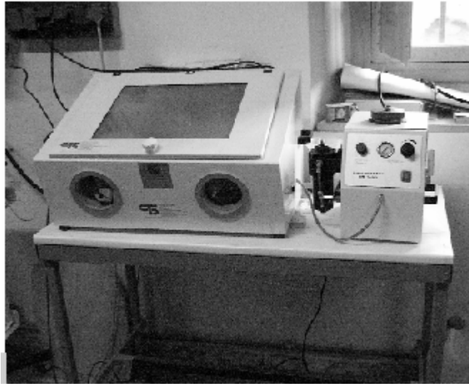
Figura 1 • Apparecchiatura per la microsabbatura di precisione in laboratorio. (OPD)
