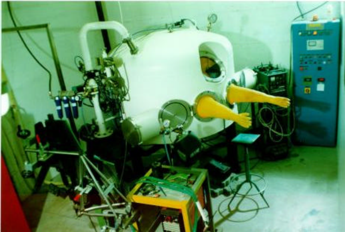
Figg. 8 e 9 • Tipiche attrezzature, disponibili in commercio, per la saldatura di componenti in titanio di medio piccole dimensioni. Nella camera stagna, in cui viene immesso il gas inerte, l'operatore può manovrare inserendo le mani nei fori che, mediante i guanti, non consentono la fuoriuscita del gas e delle parti sottili prodotte dalla lavorazione. La saldatrice ed altri utensili si trovano già all'interno della macchina. La saldatura è attualmente eseguibile con tre procedure standardizzate illustrate in fig. 8.
