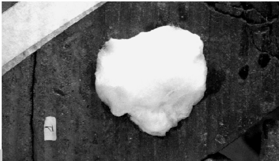
Figura 4 • Un tamponcino di ovatta imbevuta di solvente è lasciato agire brevemente sulla superficie ceramica. (OPD)
