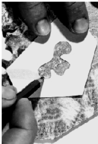
Figura 2 • Disegno di un singolo pezzo sulla lastra di materiale mediante un modello in cartoncino. (OPD)
