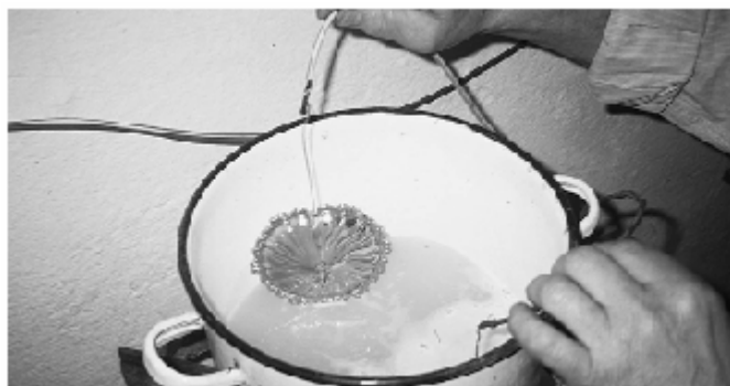
Figura 6 • La doratura avviene in un bagno galvanico con cianuro di sodio e oro, in cui l'anodo è costituito dal metallo di ricopertura e il catodo dal pezzo da ricoprire.
