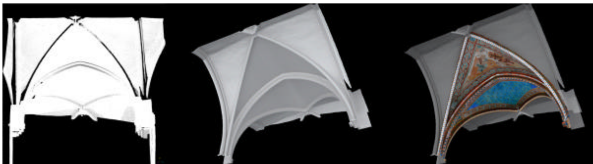
Figura 27 • Basilica Superiore di Assisi. Nuvola di punti, mesh e texture fotografica; elaborazioni sperimentali per il Ministero per i Beni e le attività culturali in occasione della ricostruzione virtuale della volta della Basilica, 2004. (SAT)
