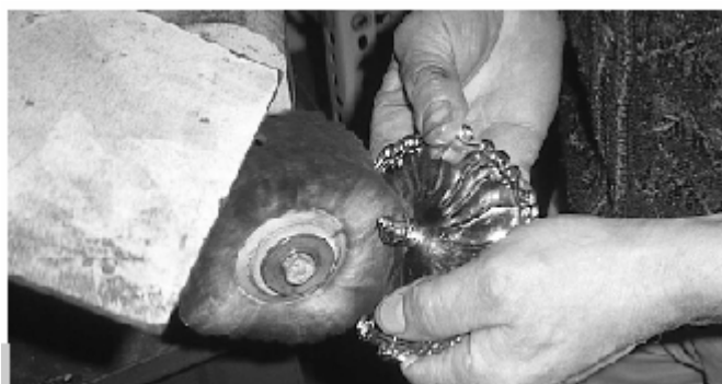
Figura 5 • L'oggetto va asciugato e, con una mola, sottoposto ad una prima lucidatura per eliminare ogni traccia di impurità.
