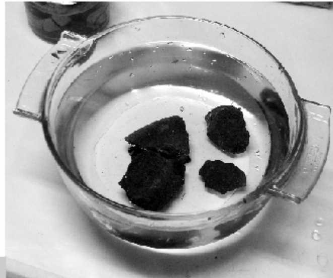
Figura 1 • Immersione di frammenti ceramici in acqua deionizzata. Sono utilizzate vasche di vetro, di materia plastica o 1 di acciaio inox. (OPD)
