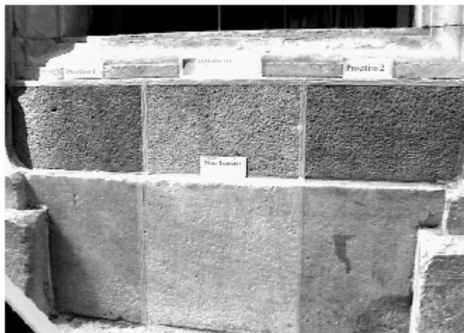
Figura 4 • Provini per l'applicazione di due prodotti protettivi su "pietra di Finale" (calcare arenaceo fossilifero). I due differenti prodotti ancora umidi, applicati nei settori di destra e di sinistra, contrastano ancora con la superficie non trattata. (SAL)
