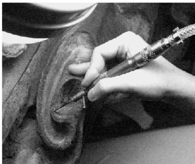
Figura 2 • Il martelletto vibratore applicato su dettagli di una scultura di bronzo. (OPD)
