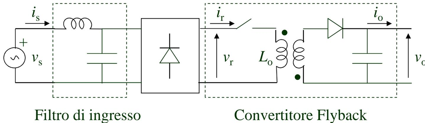
Se non si inserisce un condensatore di filtro all'ingresso del flyback, quest'ultimo assorbe necessariamente una corrente discontinua.
