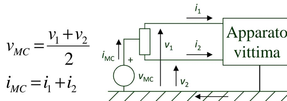
La modalità di accoppiamento conduttivo è propria soprattutto dei **disturbi in bassa frequenza**, cioè armoniche di corrente assorbite da carichi non lineari, armoniche di tensione (causate dalle cadute sulle impedenze del sistema di distribuzione), interarmoniche di corrente, variazioni di frequenza, buchi di tensione (causati dall'inserzione di grossi carichi), sovratensioni transitorie (causate dalla disinserzione di grossi carichi), flicker.
