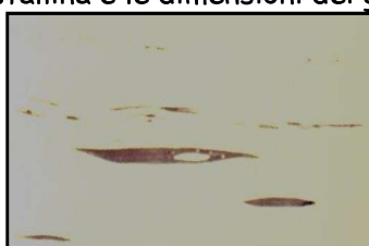
Stringler longitudinali di inclusioni (esame macroscopico).
