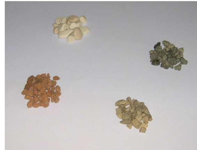
**Gli aggregati costituiscono più del 90 % in peso dei conglomerati bituminosi impiegati nelle pavimentazioni stradali**
