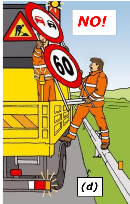
Figura 16 – Prelevamento della segnaletica da automezzo: comportamenti corretti (a), (c) e scorretti (b), (d)
