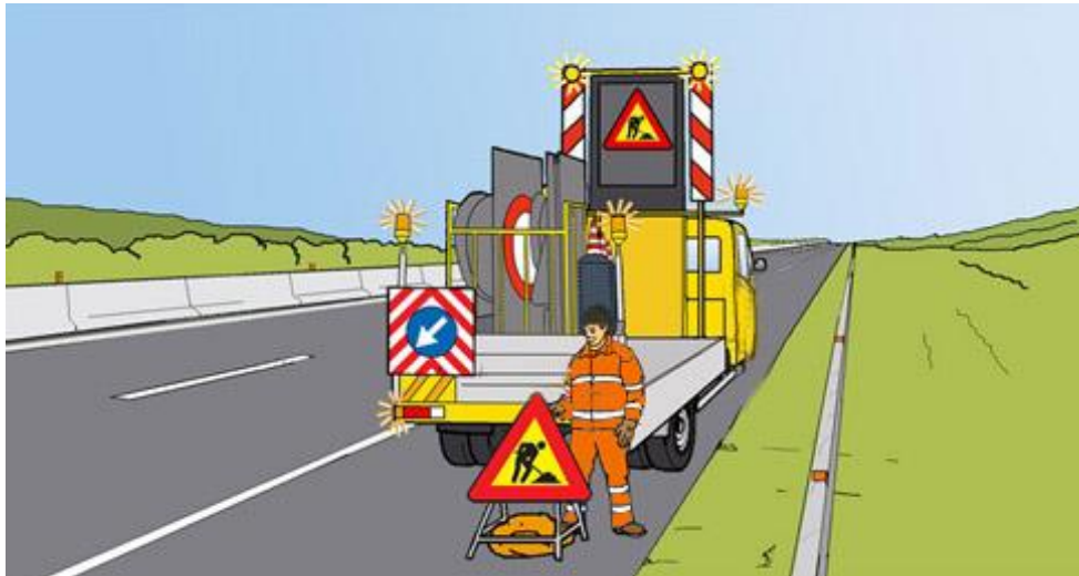
Figura 18 – Chiusura della corsia di emergenza: installazione del cartello di lavori in corso
