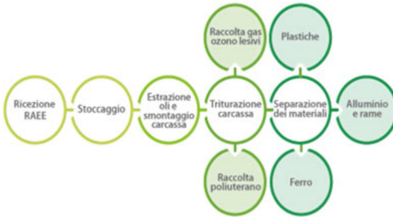
Figura 6.2. Diverse fasi del recupero di materiali da RAEE
