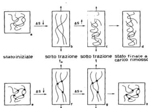
Figura 10 - Deformazione di una gomma, effetto della reticolazione, variazione di entropia con la deformazione (da ref.1)
