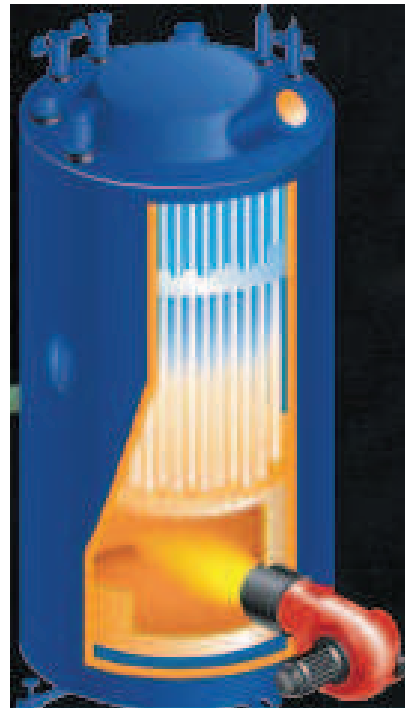
Figura 6 - Caldaia a nafta a tubi di fumo lisci (“plain smoke tube boiler”)
