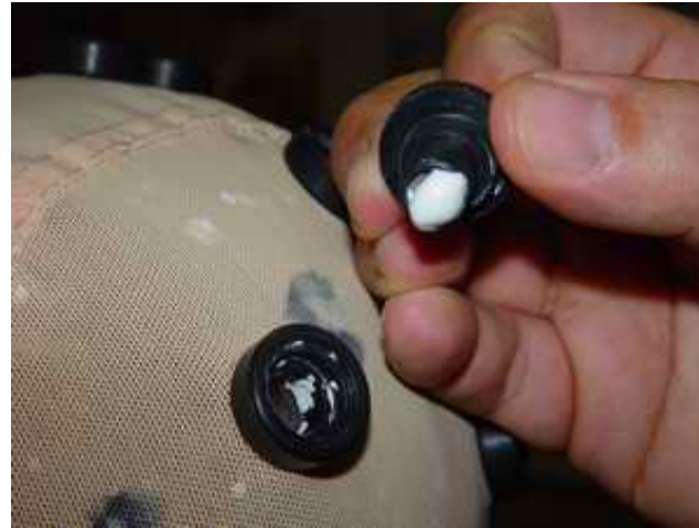
pasta conduttrice applicata sull'elettrodo
