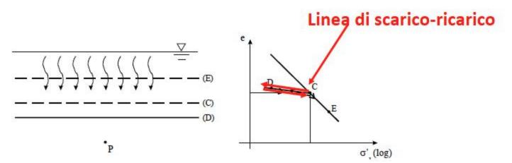
Al procedere del ricarico tensionale (fino al raggiungimento della pressione di preconsolidazione  $\sigma'_{p} = \sigma'_{v}(C)$  il coefficiente di spinta a riposo,  $K_{0}(OC)$ , diminuisce all'aumentare della tensione efficace verticale raggiunta (ovvero al diminuire di OCR)
