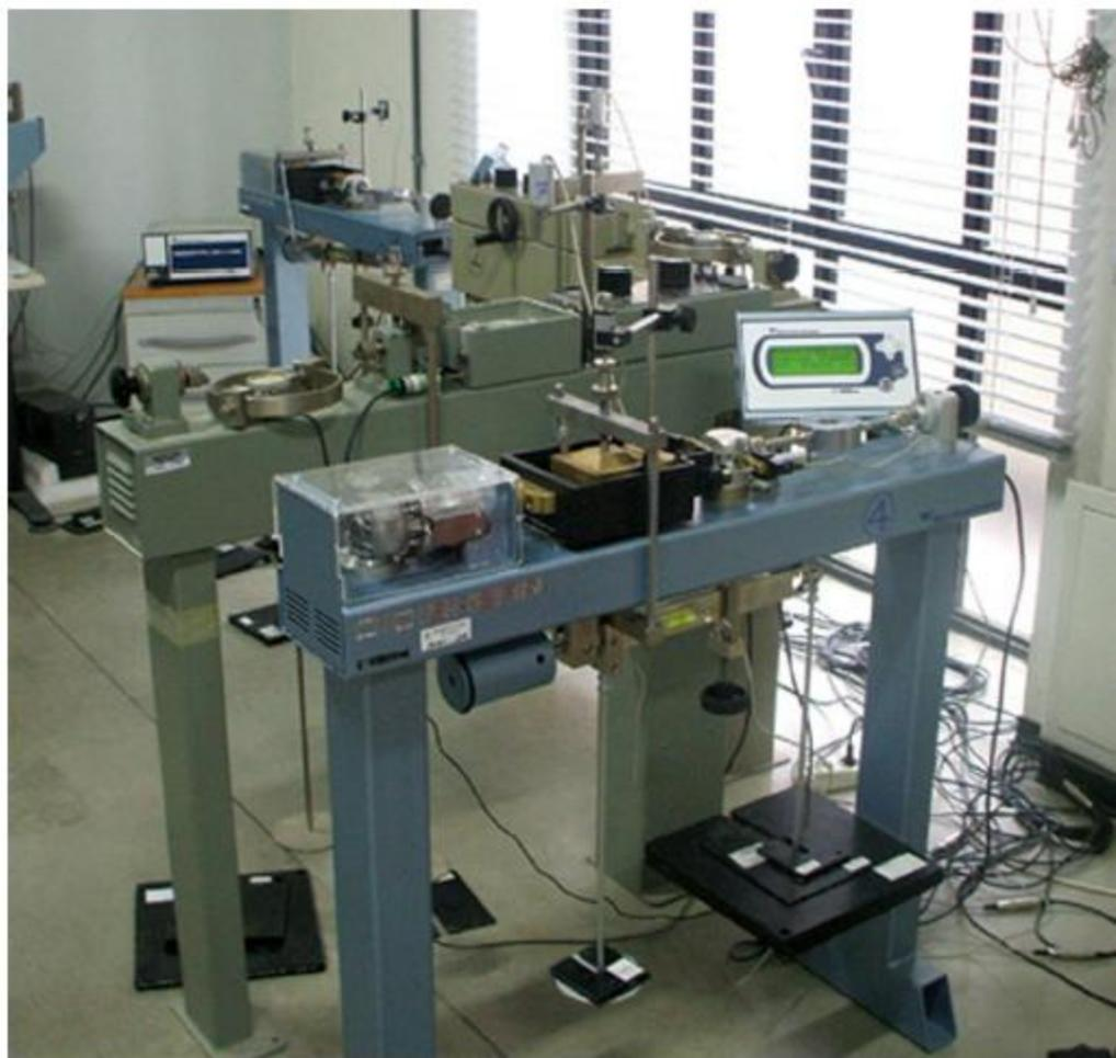
**ATTREZZATURA:** il provino è un prisma a sezione quadrata (lato =  $60 \div 100 \text{ mm}$   $\gg$  altezza =  $20 \div 40 \text{ mm}$  per velocizzare il processo di consolidazione e ridurre l'attrito laterale)
