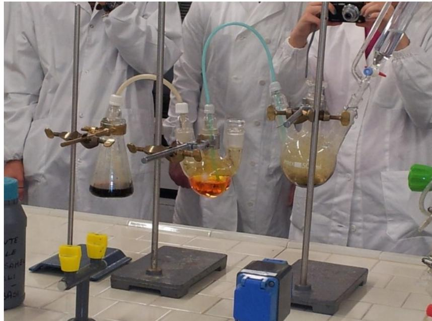
Per la connessione di attrezzature diverse in vetro si usano spesso **giunti conici smerigliati normalizzati**
