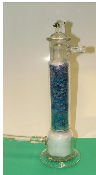
Torre di Fresenius per purificazione di gas. Contiene un essiccante: es.  $\text{CaCl}_2$  con un indicatore di umidità.
