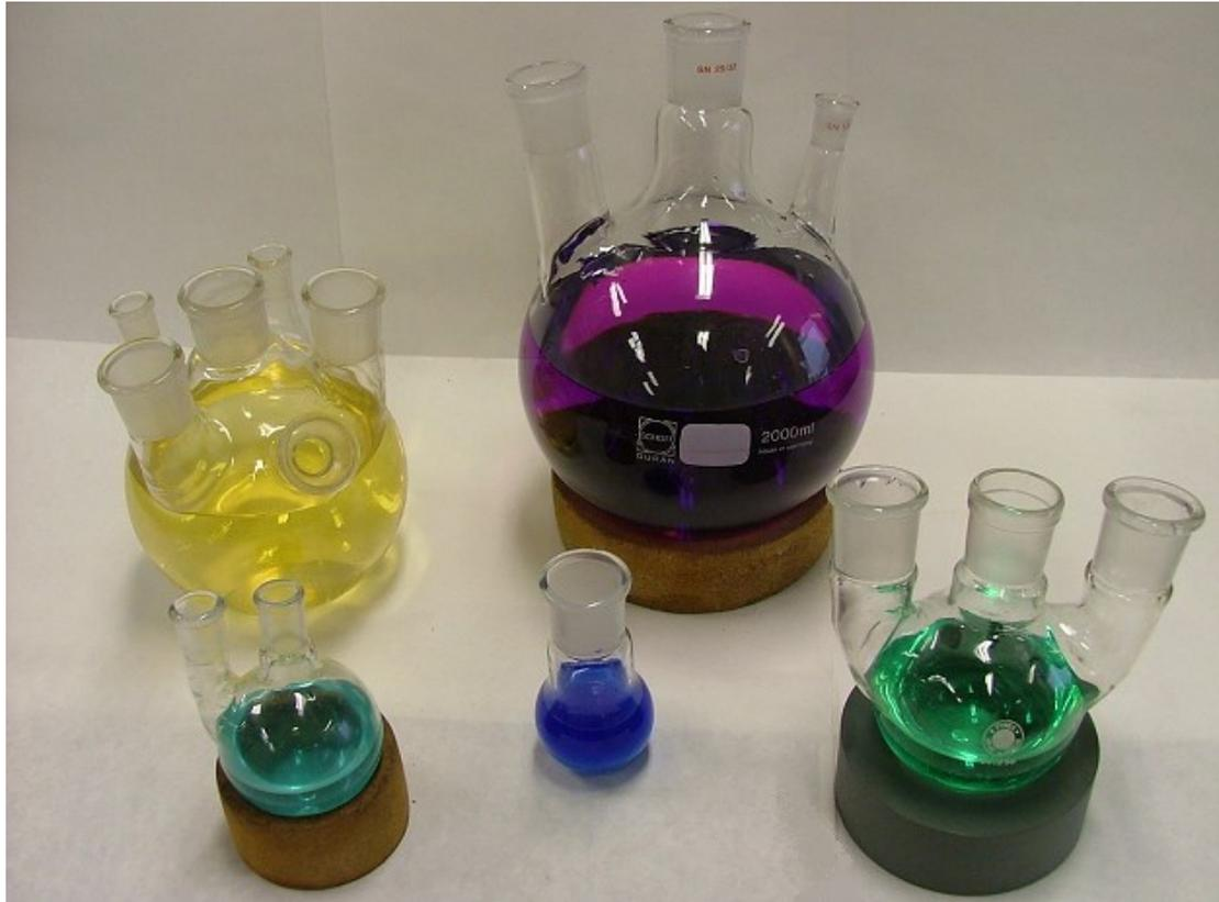
Palloni da reazione in vetro Pyrex o Duran di vari volumi, a uno o più colli normalizzati con diverso diametro
