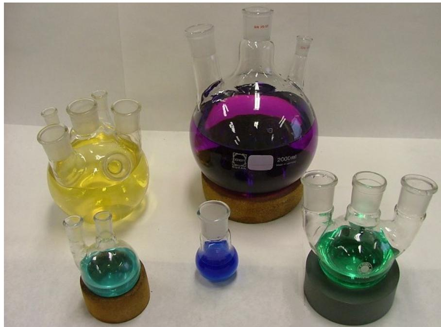
per reazioni chimiche: **pallone da reazione**. Se da riscaldare: **con mantello riscaldante e colonna refrigerante di Allihn**
