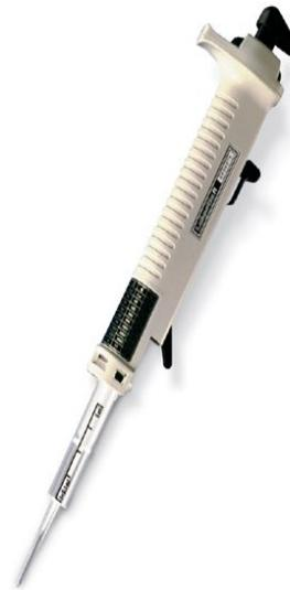
Per aggiunte molto accurate e precise di volumi molti piccoli, anche meno di 1  $\mu\text{L}$  e fino a qualche mL: **siringhe**
