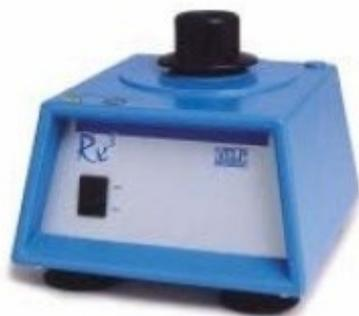
agitatore meccanico per provette "vortex"
