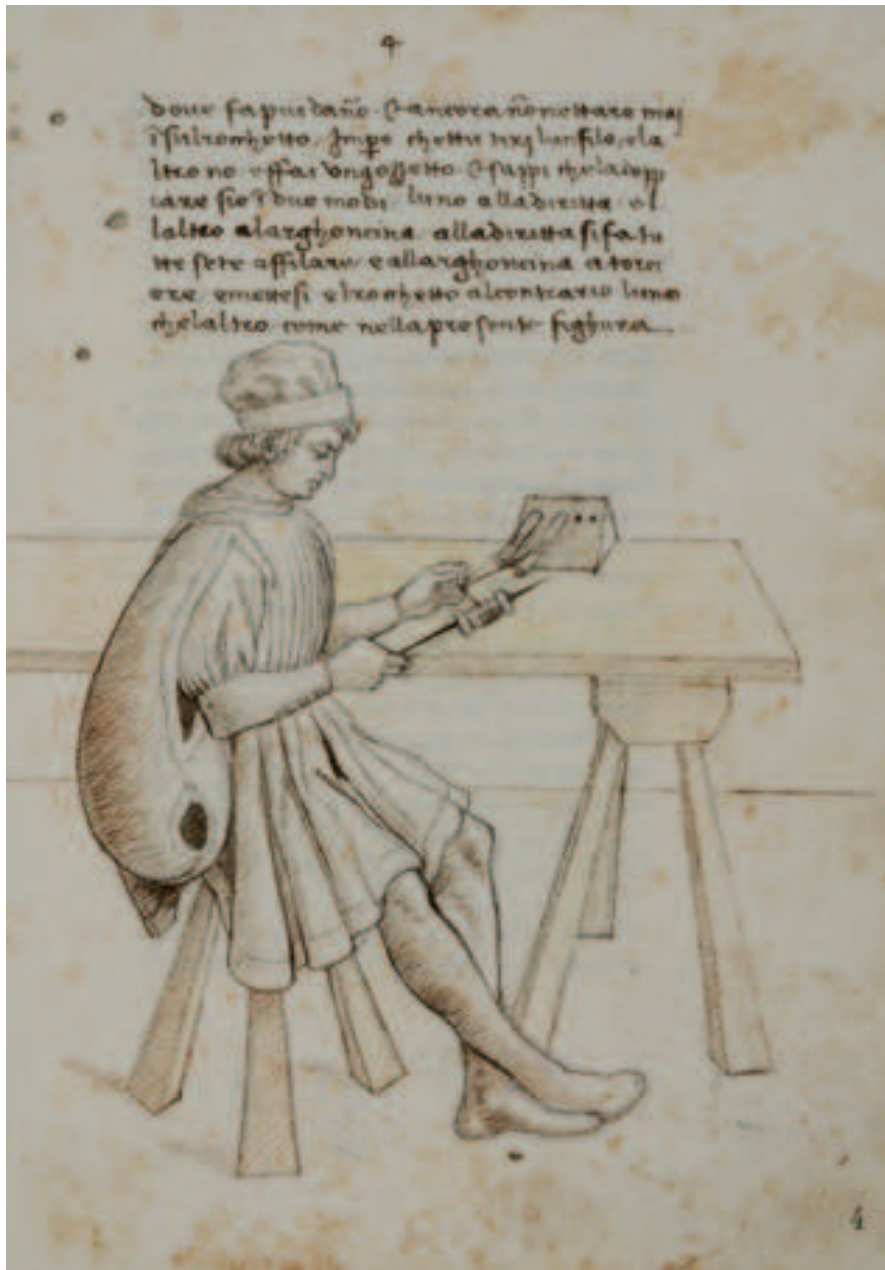
12. Lavorazione della seta a Firenze nel XV secolo: avvolgimento del filo di seta sul rochetto. Firenze, Biblioteca Riccardiana. [reg. 124]
