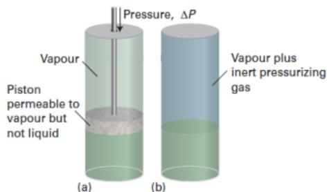
il liquido può essere sottoposto a una pressione esterna differente dalla pressione di vapore alla data  $T$
