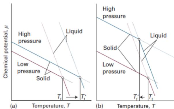
variazione di  $T_f$  con  $p$ : (a) caso  $V_m(l) > V_m(s)$ ; (b)  $V_m(l) < V_m(s)$
