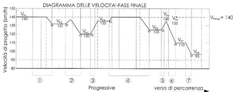
Per  $V_{pmax} \geq 100$  km/h (autostrade, strade extraurbane principali e secondarie) nel passaggio da tratti caratterizzati dalla  $V_{pmax}$  a curve a velocità inferiore, la differenza di velocità di progetto non deve superare 10 km/h. Inoltre, fra due curve successive tale differenza, comunque mai superiore a 20 km/h, è consigliabile che non superi i 15 km/h.
