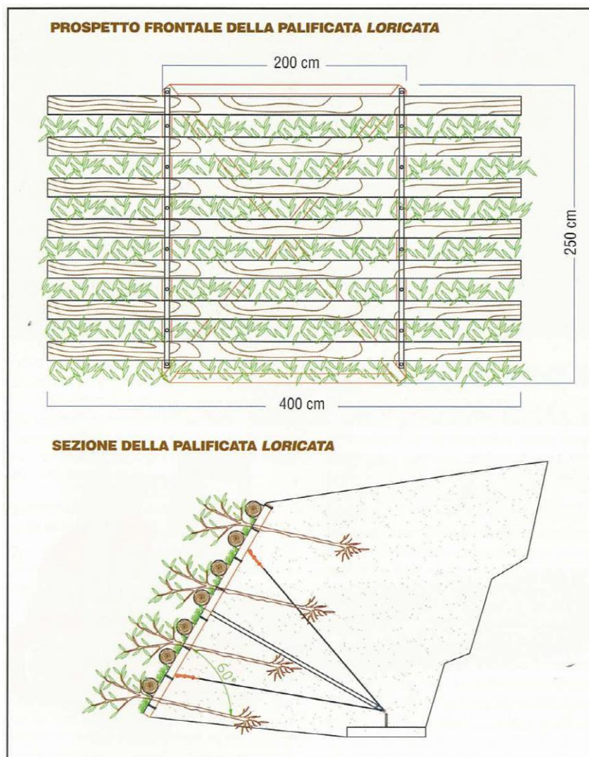
Figura 98 - Palificata loricata - prospetto frontale e sezione.
