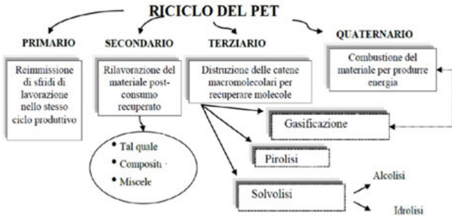
Figura 3.1. Esempi di riciclo del PET classificati secondo la classificazione primario, secondario, terziario e quaternario
