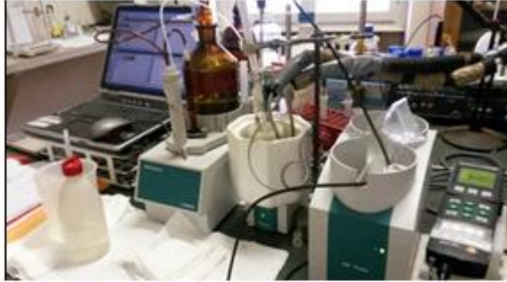
Figura 18. Titolatore automatico "Metrohm 685 Dosimat" usato per l'analisi dei campioni di A_T .
