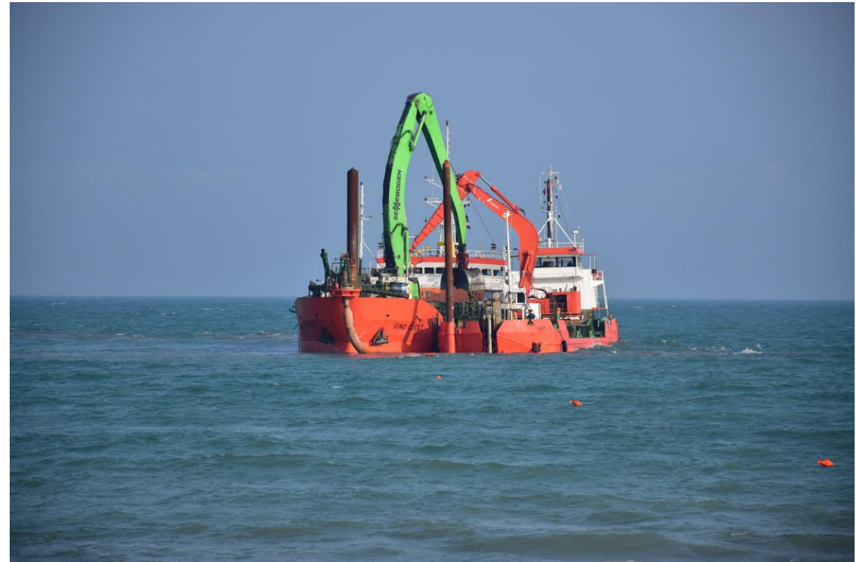
Trasbordo da bettolina a TSHD per incrementare ulteriormente la produzione e limitare i tempi morti
