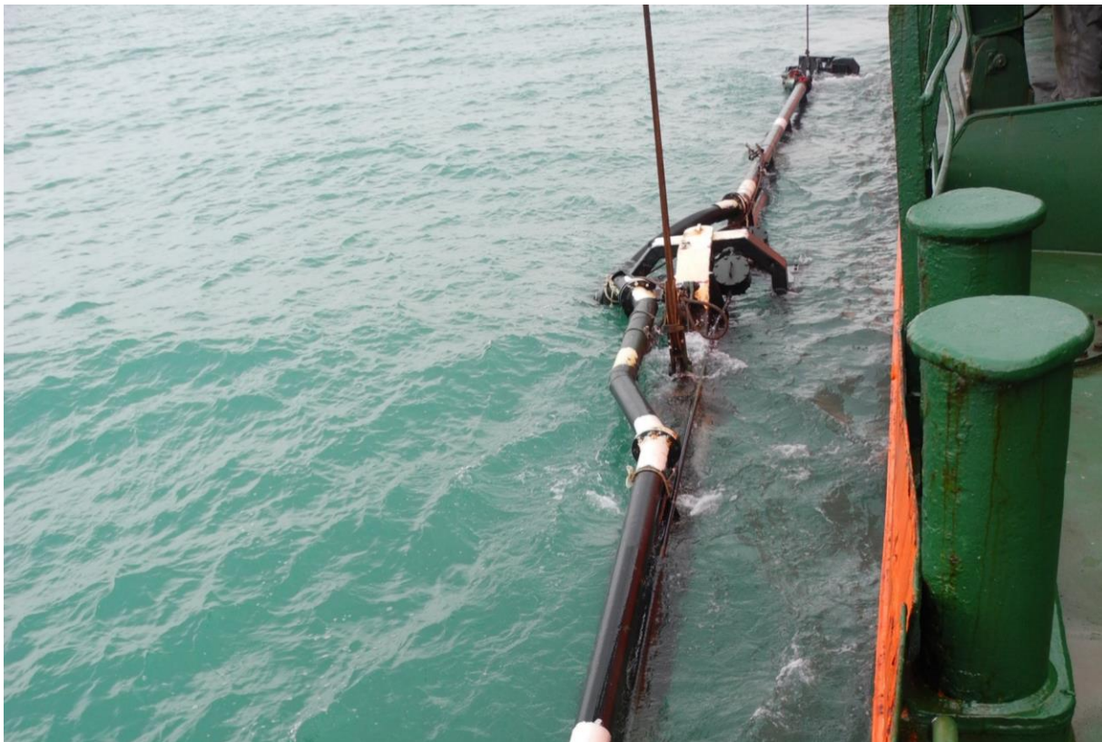
Abbassamento drag head sul fondo per livellazione di precisione
