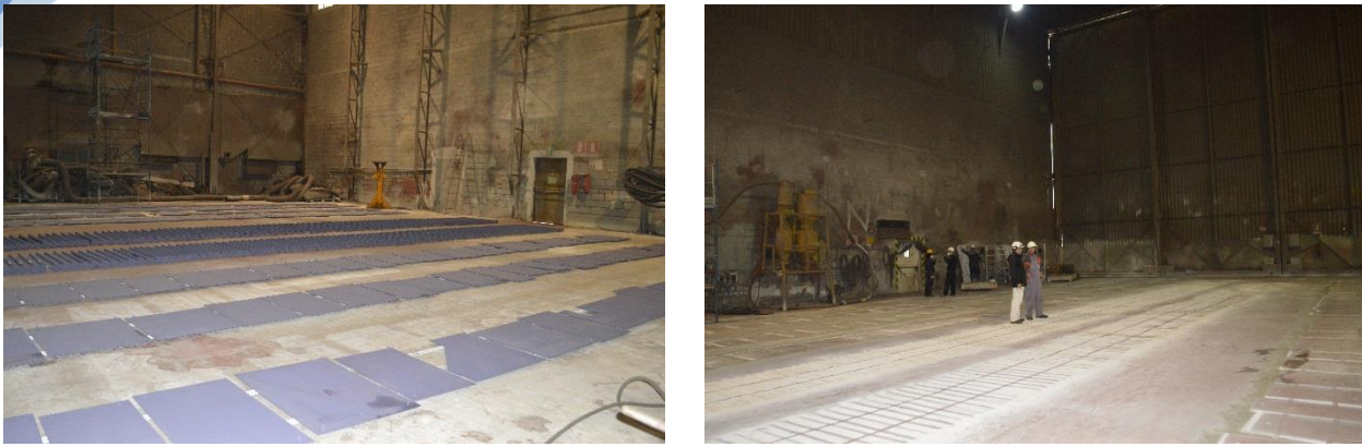
Figura 126 Pitturazione di elementi di paiolato. Manufatti predisposti per la pitturazione (sinistra) e relativi depositi di vernice (destra)
