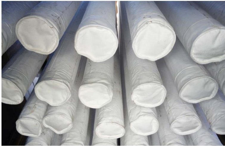
Figura 62 Maniche viste dal lato di ingresso dell'aria polverosa
