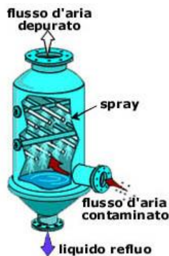
Figura 66 Schema di torre spray
