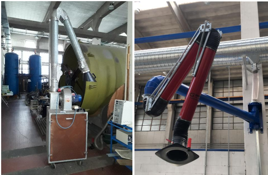
Figura 98 Cappa mobile: soluzione portatile e collegamento ad impianto centralizzato
