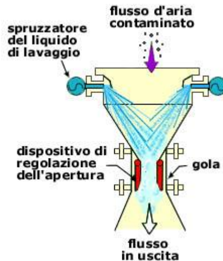
Figura 73 Depuratore Venturi – Principio di funzionamento
