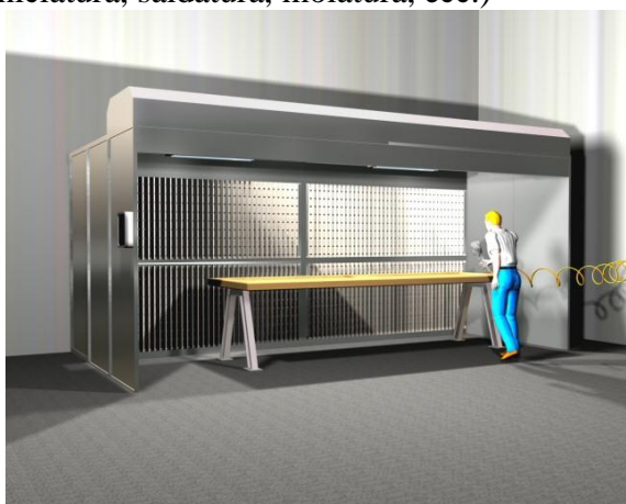
Figura 29 Cabina di verniciatura a chiusura parziale (a sinistra) e a chiusura totale (a destra)
