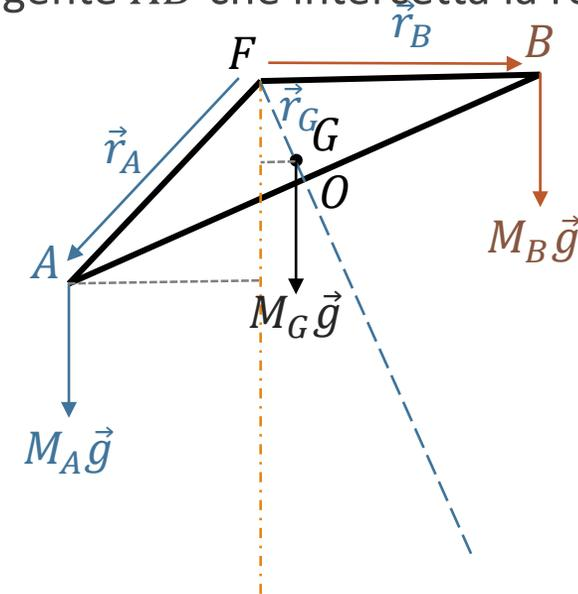
La condizione di equilibrio è data da:  $\vec{r}_A \times \vec{P}_A + \vec{r}_B \times \vec{P}_B + \vec{r}_G \times \vec{P}_G = 0$  che mi da per l'angolo  $\alpha$  la relazione
