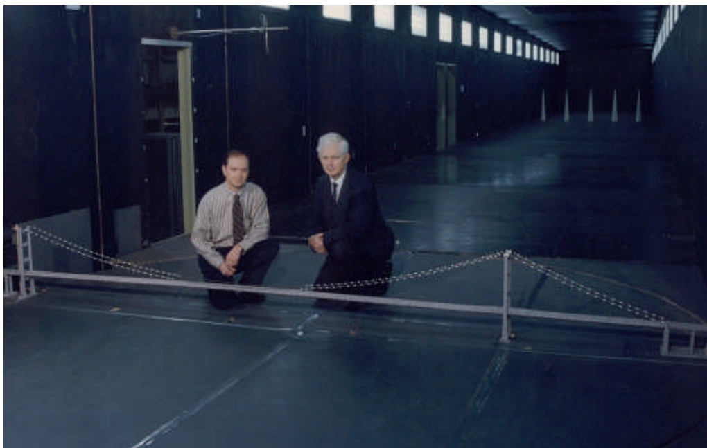
Figura Q.7 – Prova su replica aeroelastica di ponte sospeso.
