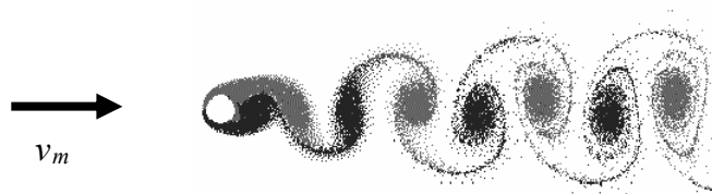
Figura O.1 – Scia di von Kármán per una sezione circolare.
