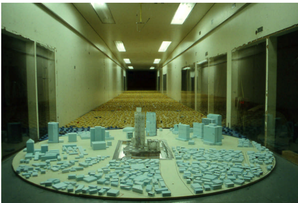
Figura Q.4 – Prova manometrica.
