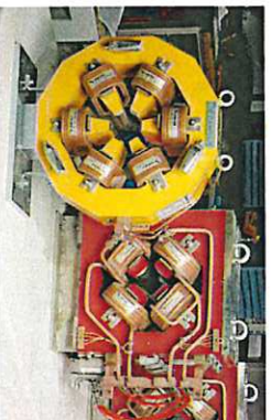
Figura 27 - struttura di quadrupoli e sestupoli
