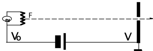
Figura 2.1. - Schema di principio di un acceleratore elettrostatico
