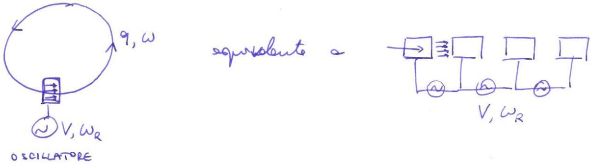
In entrambi i casi, la presenza di un oscillatore impone le richieste di sincronismo fra il verso del campo elettrico e il percorso delle particelle nello elemento a RADIO FREQUENZA (RF). L'accelerazione finale (guadagno di energia) è fornita dal percorso consecutivo delle particelle - generato ALTROVE - nell'elemento RF.
