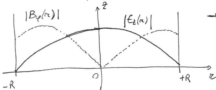
→ per fasci accelerati sull'asse delle celle e le cui dimensioni trasverse sono  $\ll R$ , possono considerare  $B_y = 0$  e  $E_z \neq 0$  ai fini della dinamica.
