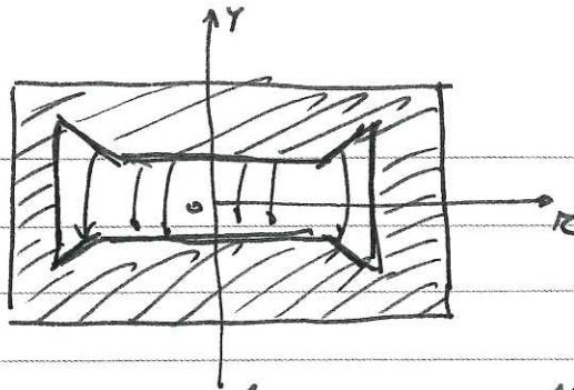
$$\left\{ 2\pi r E_0(r) = -\pi r^2 \frac{d\bar{B}(r)}{dt} \right. \quad \left. \begin{array}{l} \text{induzione magnetica MEDIA sulla} \\ \text{superficie di area } \pi r^2 \text{ ricevuta dalla} \\ \text{circonferenza con raggio } r. \\ E_0(r) : \\ \text{il campo elettrico (tangenziale) calcolato al} \\ \text{raggio } r. \end{array} \right.$$
