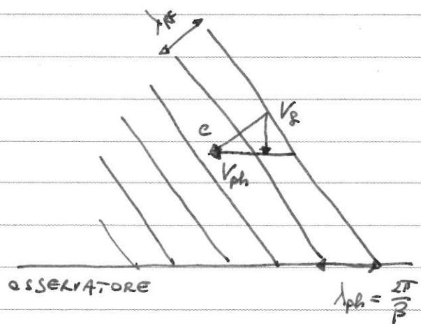
$c$  = velocità di propagazione dell'onda e.m. nel vuoto
