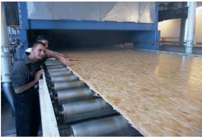
Pannello „ininterrotto“ sui rulli della pressa
