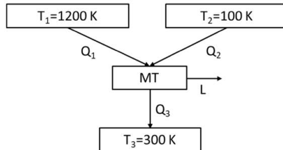
La potenza termica assorbita dai due SET si calcola applicando il primo principio alla macchina termica:
