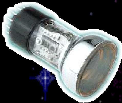
A seconda dell'elemento utilizzato come catodo, si possono costruire fotomoltiplicatori sensibili allo spettro elettromagnetico dai raggi X all'infrarosso.
