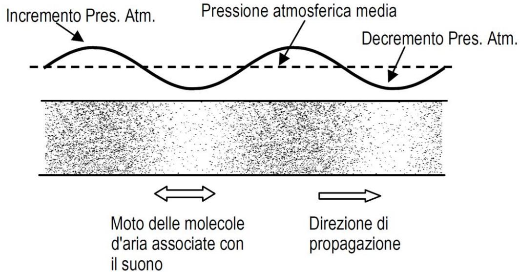
**Figura 2.36** Schema della propagazione dell'onda sonora.
