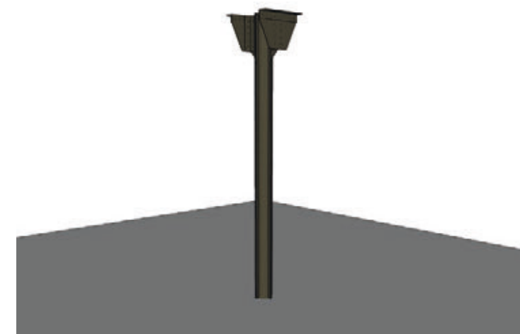
Figura 64 - Elemento puntuale in elevazione in ghisa, in evidenza il capitello superiore
