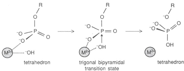
abbassare l'energia dello stato di transizione di una reazione associativa tramite la coordinazione di entrambi i reagenti. In figura viene riportato un semplice modello per l'idrolisi del fosfato catalizzata da uno ione  $\text{M}^{2+}$ . Si presume che l'idrolisi del fosfato, che è una **sostituzione nucleofila**, avvenga con **meccanismo associativo**
