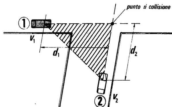
Nelle intersezioni dove vige la regola generale di precedenza a destra la zona di visuale libera va realizzata verificando sui rami di intersezione la distanza di visibilità per l'arresto.
