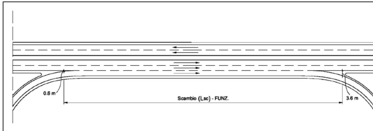
**Le zone di scambio. Queste si hanno quando avviene l'attraversamento reciproco di due correnti di traffico aventi medesima direzione e verso, lungo un tronco stradale di lunghezza significativa**
