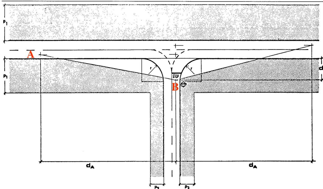
In caso di regolazione mediante segnale di STOP, il vertice del triangolo di visibilità relativo alla direzione secondaria si pone ad una distanza di 3 m dalla linea di arresto:
