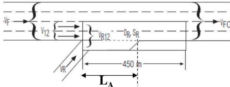
$$V \geq V_{FO} = V_F + V_R \text{ capacità tratto a valle}$$
