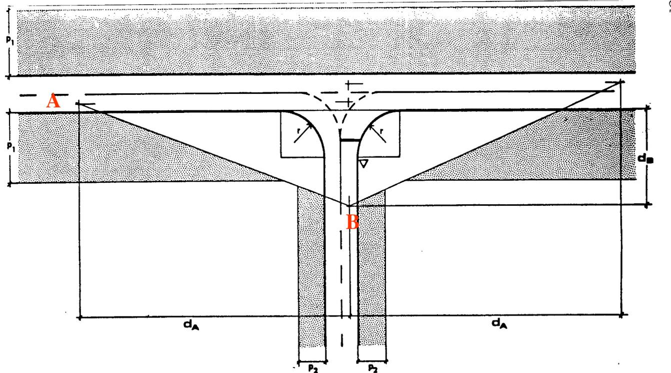
In caso di regolazione mediante segnale di precedenza, il vertice del triangolo di visibilità relativo alla direzione secondaria si pone ad una distanza di 20 m dal ciglio della strada principale:
