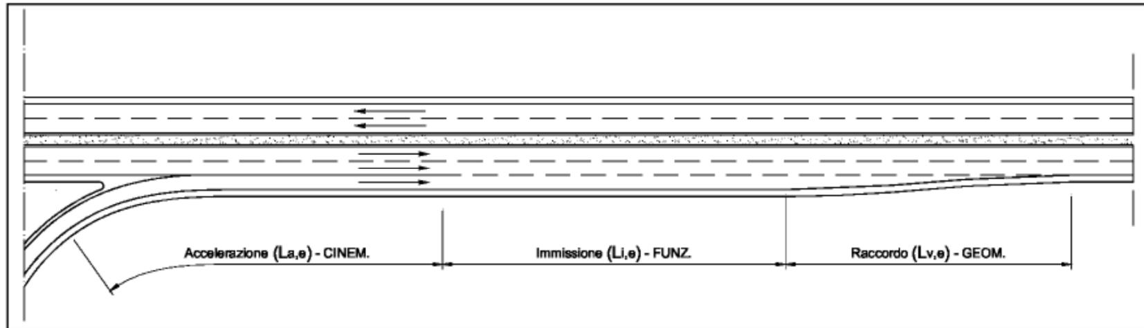
La lunghezza del tratto di raccordo  $L_{v,e}$  nelle corsie di entrata od immissione si determina in funzione della velocità di progetto della strada sulla quale la corsia si immette, sulla base della Tabella 3:
