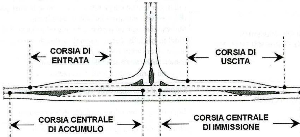
Le corsie specializzate, destinate ai veicoli che si accingono ad effettuare le manovre di svolta a destra ed a sinistra, e che consentono di non arrecare eccessivo disturbo alla corrente di traffico principale. Possono essere di entrata (o di immissione), di uscita (o di diversione) e di accumulo per la svolta a sinistra, e possono essere realizzate nelle intersezioni lineari a raso e a livelli sfalsati, secondo quanto previsto dal DM del 2006
