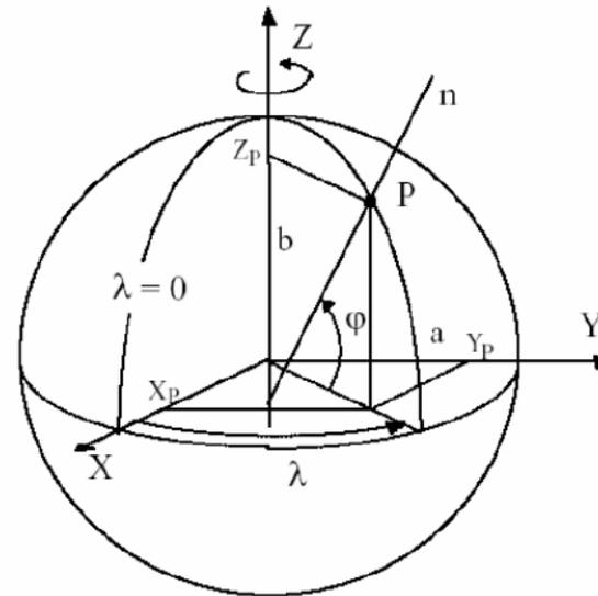
La posizione del punto  $P$  si individua con la misura dell'angolo  $\varphi$  che la normale  $n$  in  $P$  all'ellissoide forma col piano equatoriale, e la misura dell'angolo diedro  $\lambda$  che il piano contenente il meridiano passante per il medesimo punto  $P$  forma col piano contenente il meridiano origine.
