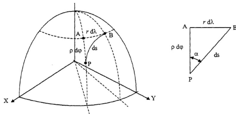
Triangolo infinitesimo sull'ellissoide di rotazione
