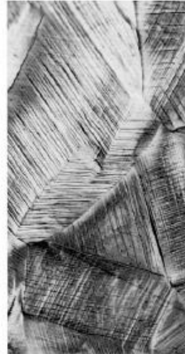
FIGURA 7.10 Linee di scorrimento sulla superficie di un campione di rame policristallino che è stato lucidato ed in seguito deformato. 1750x. (Micrografia per gentile concessione di C. Brady, National Bureau of Standards.)
