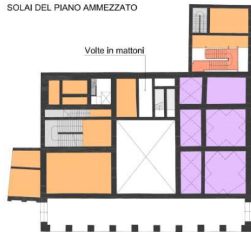
SOLAI DEL PIANO AMMEZZATO
