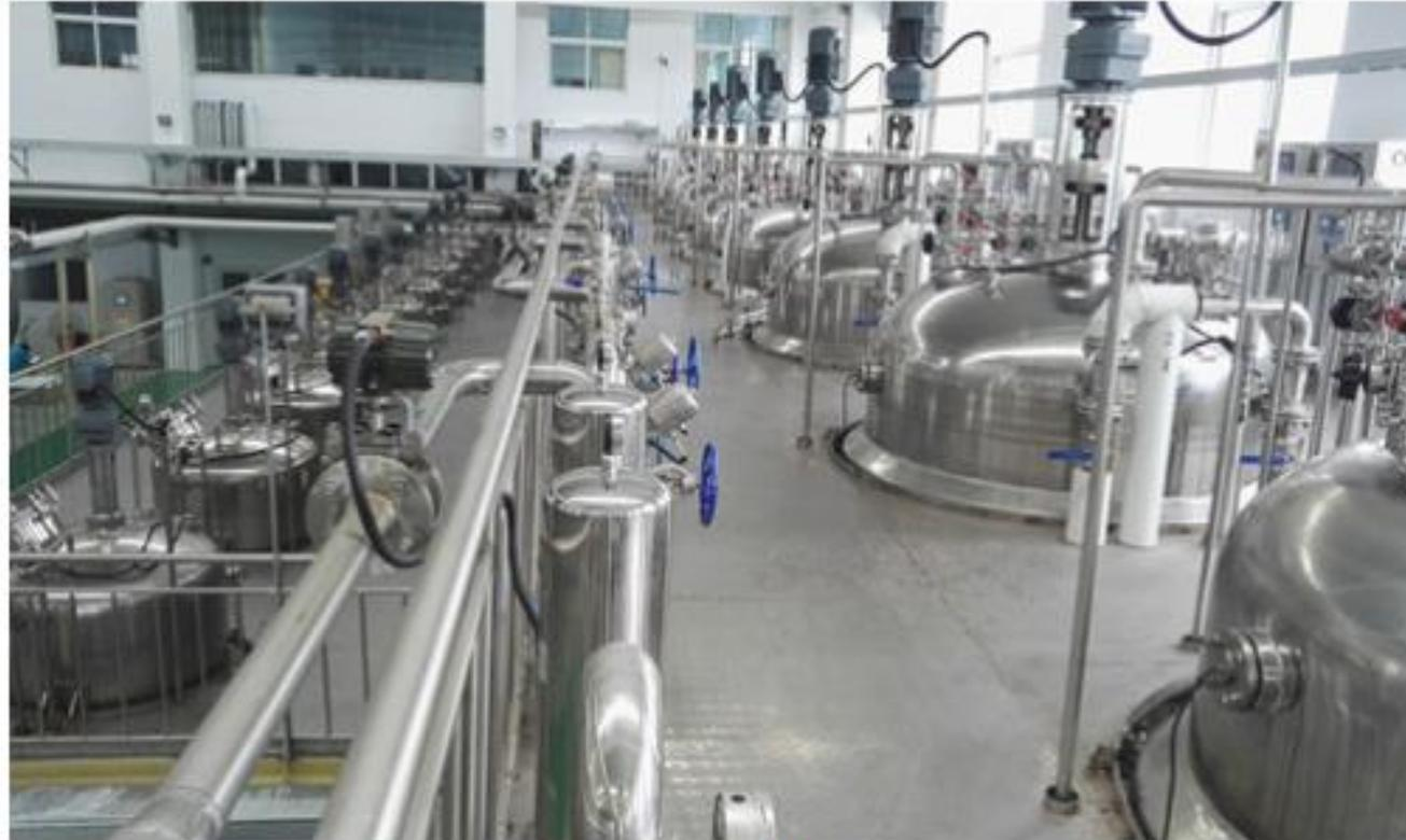
**Figura 3 - Fotografia di un impianto di fermentazione su scala industriale costituito da un numero variabile di bioreattori in acciaio collegati da tubazioni per il trasferimento di acqua e gas in uscita ed in entrata.**
