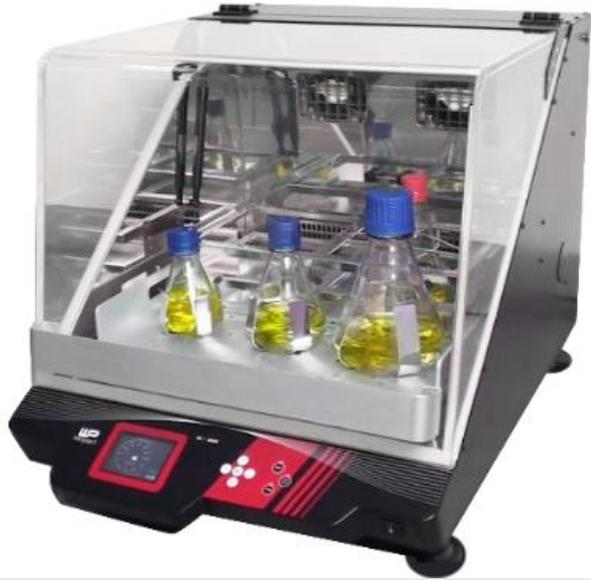
La beuta (Fig. 1), solitamente posizionata su una pedana rotante all'interno di un incubatore, presenta tutta una serie di limitazioni al monitoraggio e al controllo di alcune di queste variabili come ad esempio il pH, l'ossigenazione o l'anaerobiosi e soprattutto la sterilità poiché si tratta di un sistema aperto e non chiuso ermeticamente.
