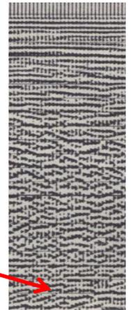
L'energia riflessa multipla viene generalmente ridotta dalle fasi del *processing standard*. Infatti, le velocità di *stack* selezionate correttamente sugli spettri di velocità riducono l'allineamento orizzontale delle riflessioni multiple.
