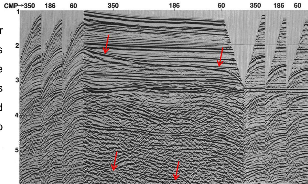
**Esempio di rimozione multiple:**
