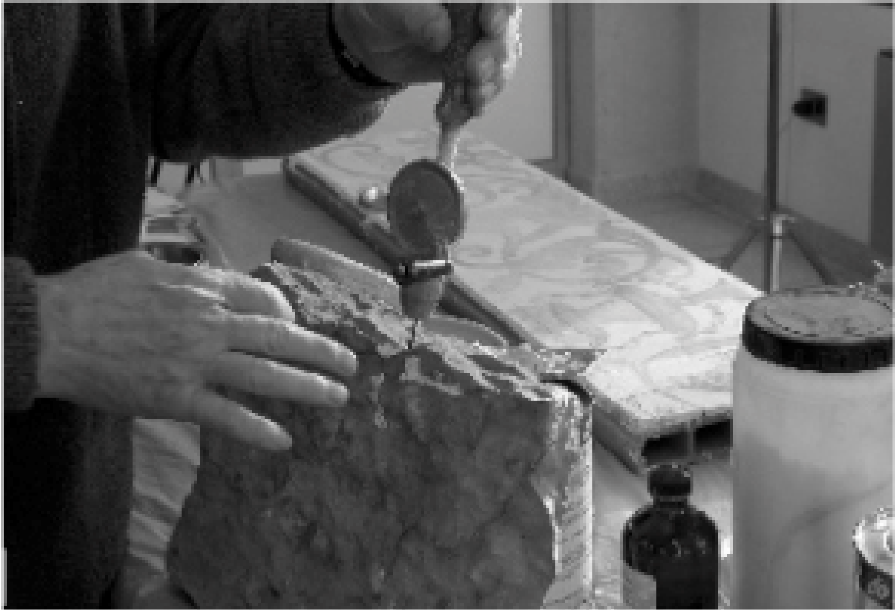
Figura 5 • Se la parte distaccata non è facilmente raggiungibile, è possibile praticare dei fori con un microtrapano con punte molto sottili.
