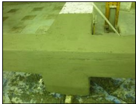
Figura 2.16 – Rinforzo di nodi travi-pilastro con tessuto metallico galvanizzato unidirezionale e malta.
