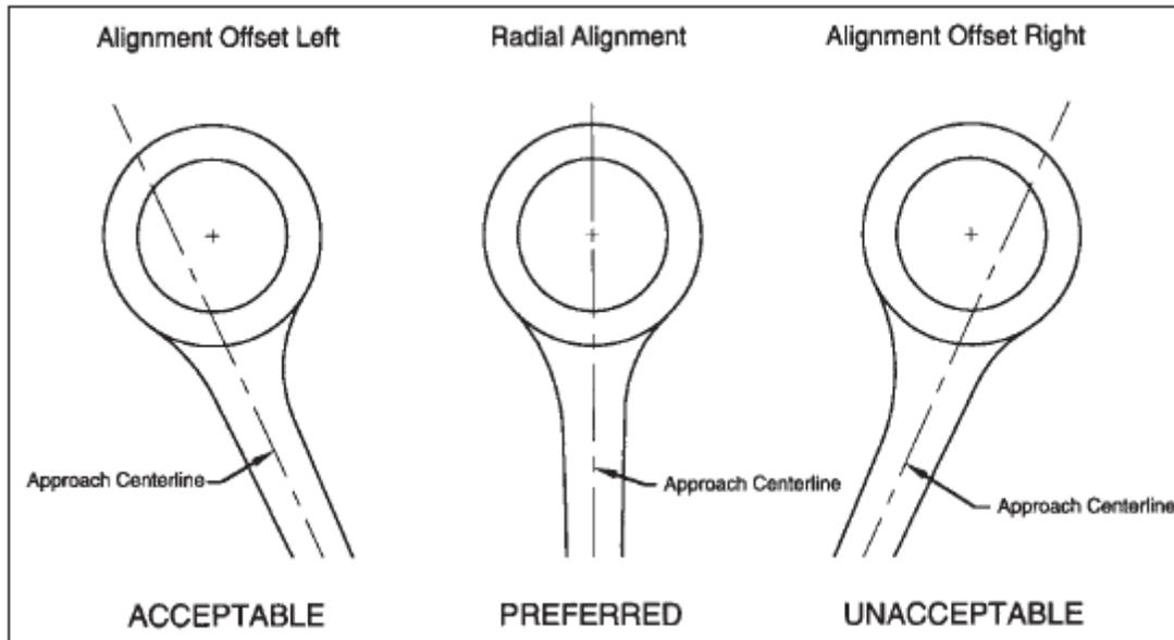
**È opportuno evitare un posizionamento dell'incrocio in curva o all'uscita da una curva; in particolare la posizione dell'isola centrale è ottimale quando tutti gli assi dei bracci che confluiscono nella rotatoria passano per il centro della rotatoria stessa**
