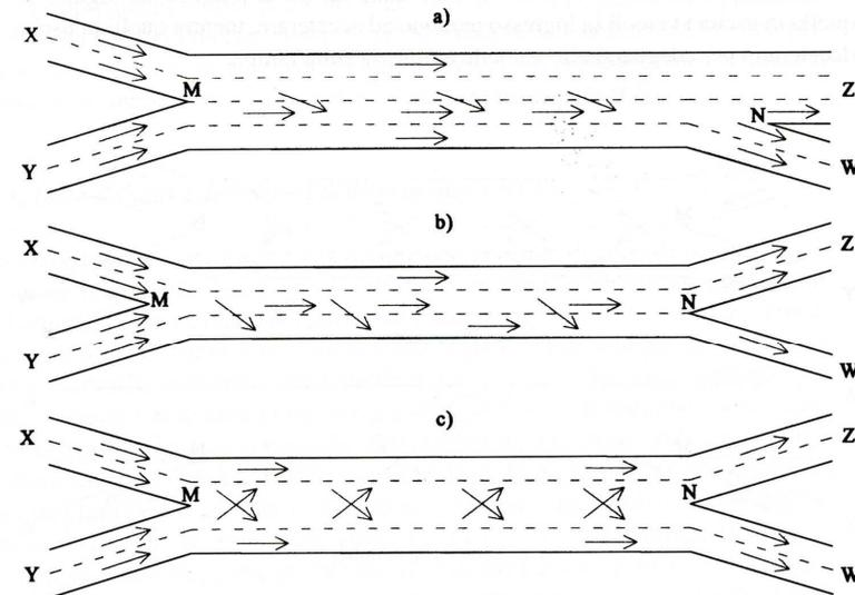
Fig.3 - Zone di scambio di tipo B
