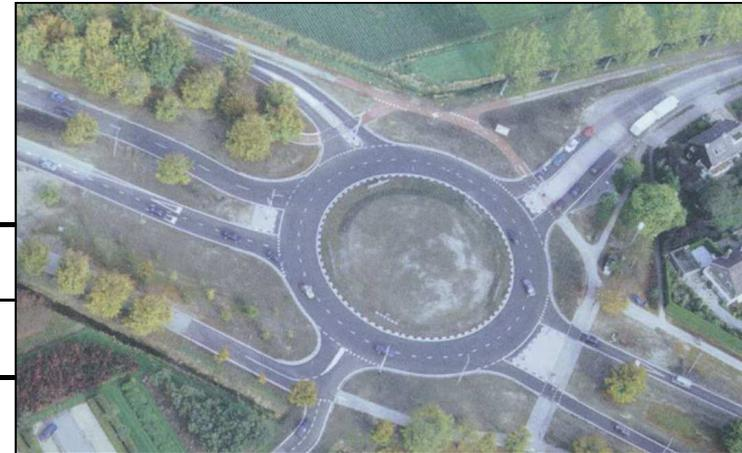
**R<sub>a</sub> 1,2** – Il ciglio destro dell’anello di circolazione è raccordato con il ciglio della carreggiata del braccio di uscita per mezzo del raggio di uscita **R<sub>a</sub>**. In analogia con quanto detto per il raggio di entrata, la geometria del bordo di connessione adotta una curva costituita da due archi di cerchio
