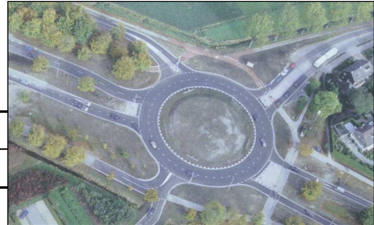
**$\alpha$**  – L'angolo di entrata  $\alpha$  caratterizza l'angolo d'intersezione tra la direzione di ingresso e la tangente all'anello di circolazione; tale angolo dovrebbe assumere valori tra a  $80^\circ$  e  $90^\circ$  per evitare velocità elevate e il mancato rispetto della precedenza; se non si possono evitare angoli di entrata minori di  $70^\circ$  è opportuno, per ragioni di sicurezza, realizzare una deviazione ben marcata per mezzo di un angolo  $\beta > 45^\circ$ .
