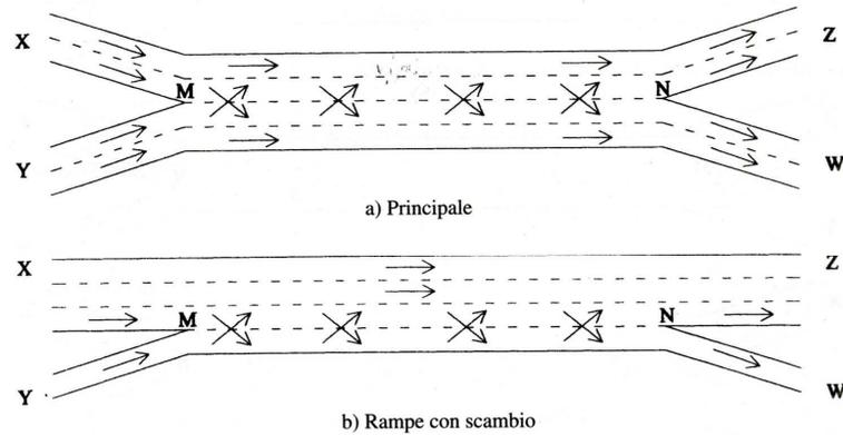
Fig.2 - Zone di scambio di tipo A
