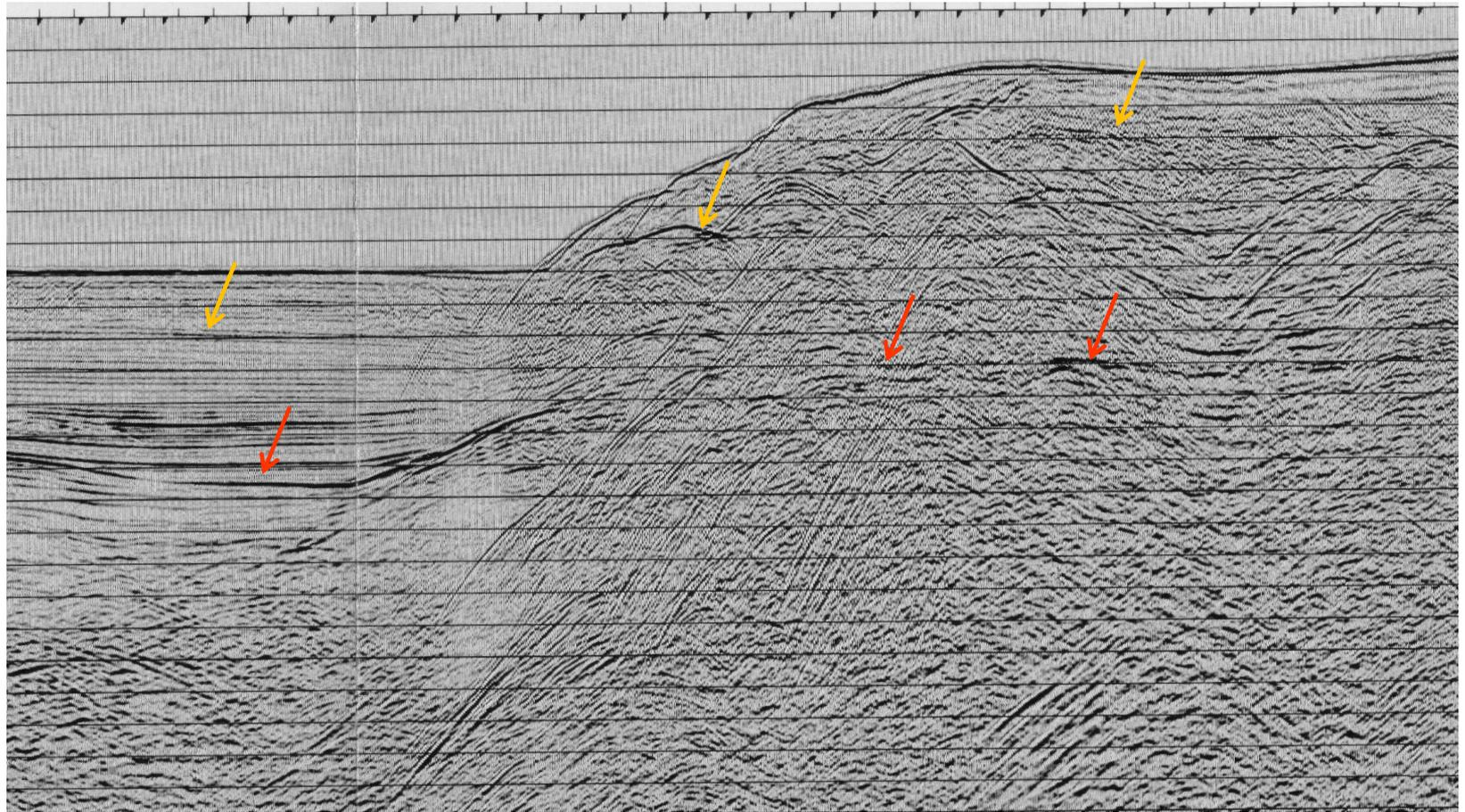
Esempio di profilo sismico non migrato attraverso un fronte compressivo: la sequenza sedimentaria dello Ionio è stata deformata nei *thrust* dell'Arco Ellenico. Le diffrazioni presenti a destra rendono difficile l'interpretazione dei riflettori caratterizzati da deformazioni e faglie inverse. A sinistra, nel settore meno deformato, gli stessi riflettori sono meglio evidenti.
