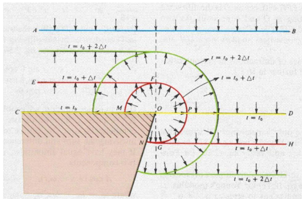
Al tempo  $t_0$  il fronte d'onda raggiunge la superficie CO e viene riflesso/diffratto; nel settore a destra il fronte prosegue verso il basso.
