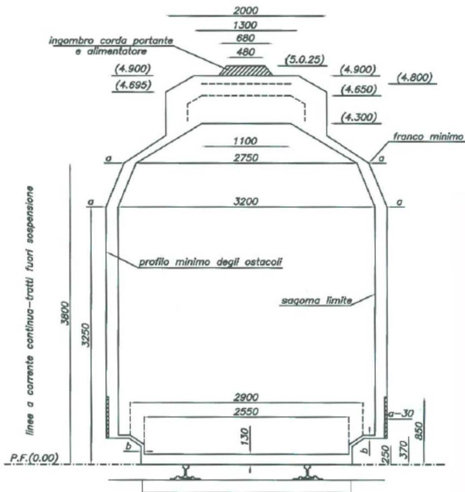
In figura è riportata la sagoma limite per le linee ferroviarie italiane. Essa include una maggiorazione nella parte superiore per consentire anche il passaggio dei pantografi e l'installazione della linea elettrica di contatto, della relativa fune portante e degli organi di sostegno della linea stessa, lasciando anche, rispetto alle apparecchiature sotto tensione, opportuni franchi, detti franchi elettrici (il Gabarit è dunque riferito anche alle linee elettrificate).
