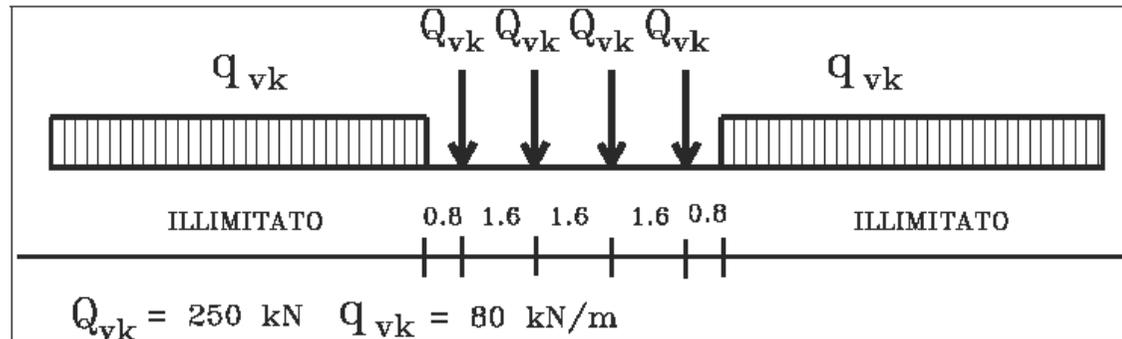
Fig. 1.4.1.2-1 - Treno di carico LM 71
