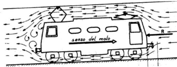
Dipende dalla sezione frontale  $S$ , dal fluido in cui ci si muove (aria)  $k$ , dalla velocità  $V$  e dall'aerodinamicità  $C$ .
