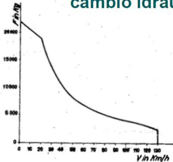
10. Caratteristica meccanica della locomotiva Diesel - elettrica D 443
