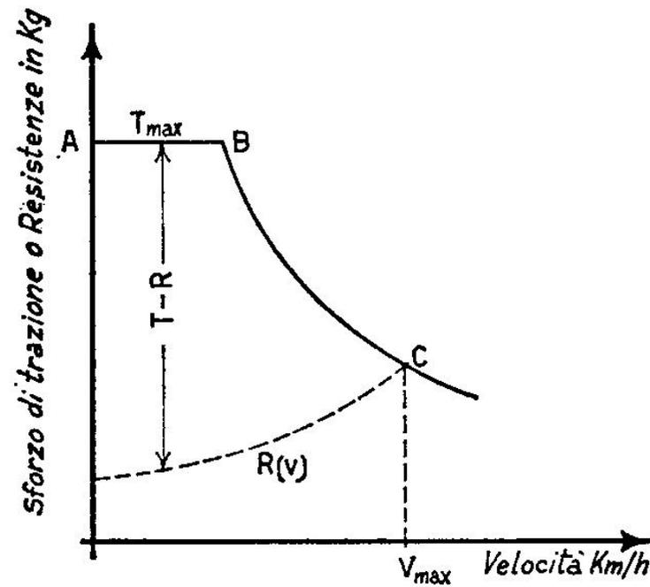
FIG. II.17 - Caratteristica di trazione (trattore a potenza costante).
