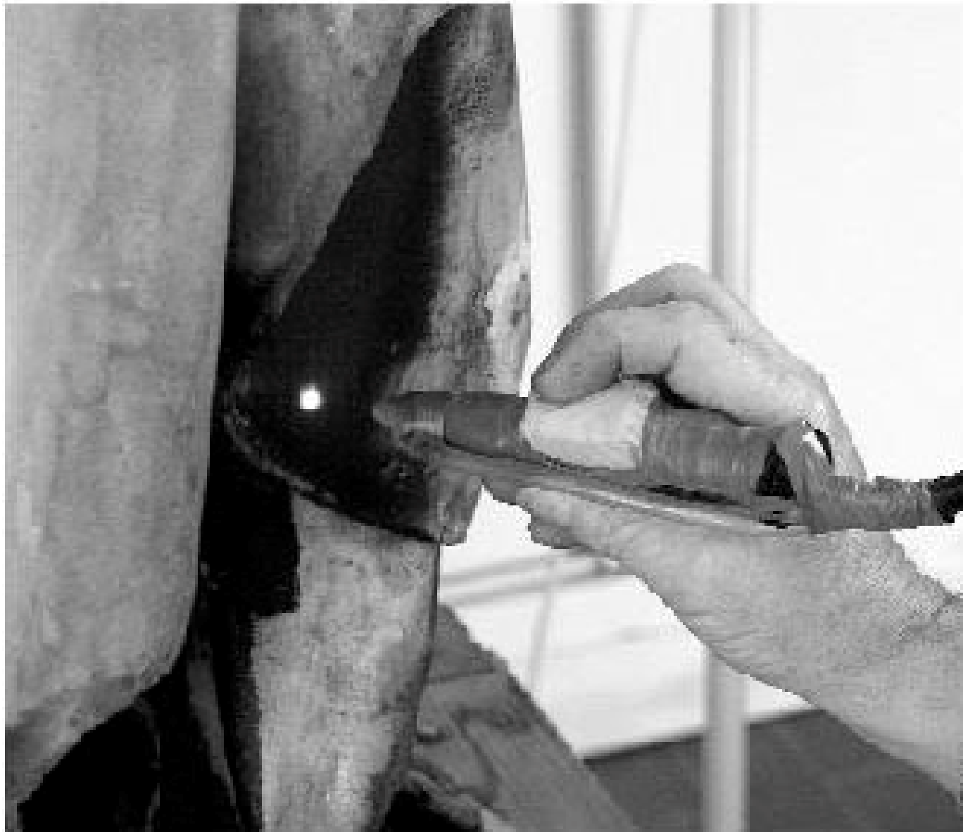
Figura 6 • In uscita, viene spesso introdotta una lente di focalizzazione, allo scopo di ottenere spot di diverse dimensioni, in funzione della distanza dalla superficie irraggiata. (SIA)
