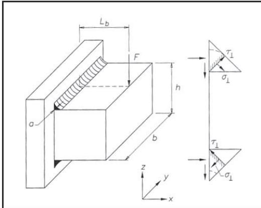
Cordoni trasversali: la sezione resistente giace nel piano verticale (y-z) ed è costituita da due sezioni rettangolari orizzontali, corrispondenti alla sezione di gola di ogni cordone di altezza a e lunghezza b.
