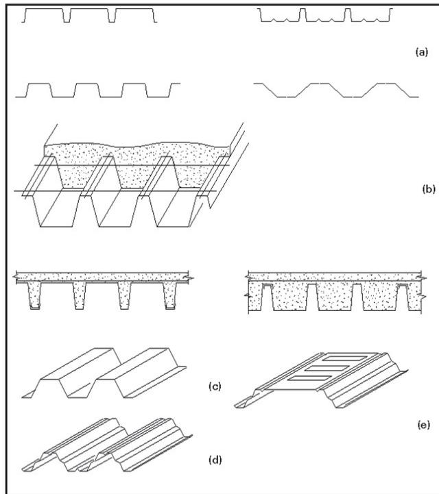
Gli elementi in lamiera grecata hanno spessore compreso tra 0.6 e 1.5 mm ed altezze variabili tra 40 e 90 mm; il collegamento con le travi può avvenire attraverso viti autofilettanti o chiodi sparati.
