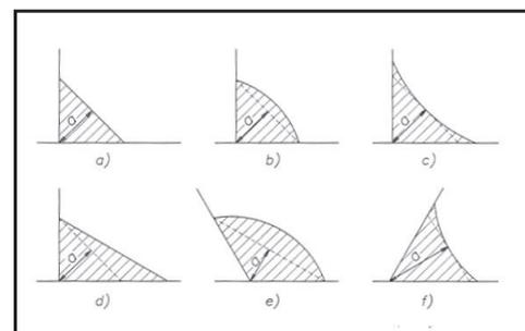
in funzione della direzione dello sforzo le saldature possono essere:
