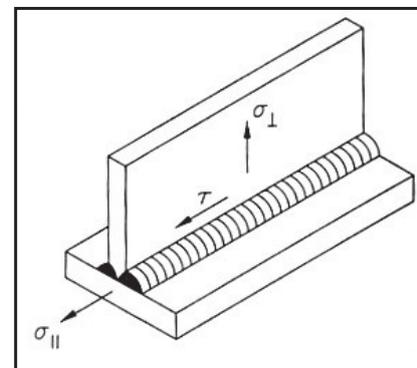
La verifica consiste nel controllare che siano verificate contemporaneamente le seguenti limitazioni distinte a seconda del tipo di acciaio:
