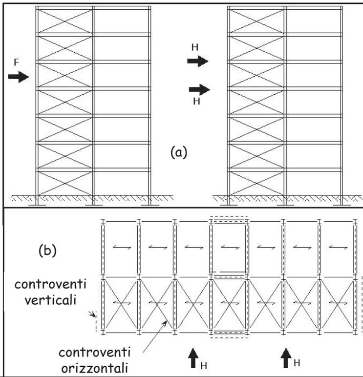
Attraverso gli elementi resistenti nel piano del solaio (controventi orizzontali) i carichi orizzontali si trasferiscono sugli elementi verticali (controventi, colonne) e raggiungono le fondazioni (b).
