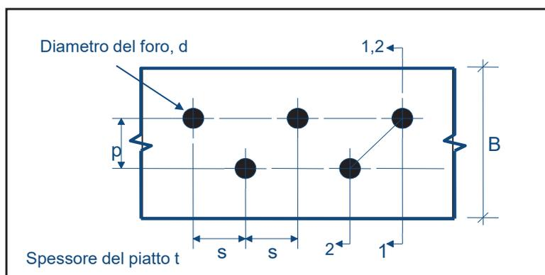
Nel caso di collegamenti non simmetrici: sezioni a L o a T collegati solo da un'ala, il calcolo di  $A_{net}$  va effettuato con le formule riportate nell'EC3.
