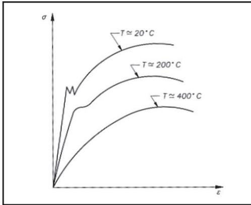
Il legame costitutivo del materiale e quindi le sue **caratteristiche meccaniche** dipendono dalla temperatura. Al crescere della temperatura diminuiscono le caratteristiche prestazionali dell'acciaio con sensibile riduzione del modulo di elasticità, della tensione di snervamento e del limite di rottura.
