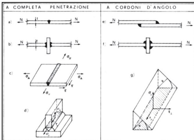
Limitatamente ai giunti a completa penetrazione, le norme (CNR10011) distinguono due classi di qualità:
