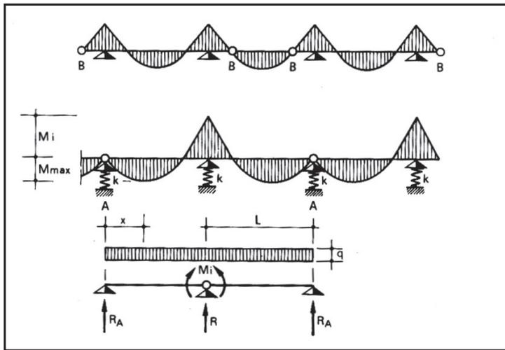
Nel caso di giunzioni in corrispondenza degli appoggi, il comportamento dell'arcareccio potrà essere ricondotto a quello di una trave su appoggi elastici la cui rigidezza dipende dalla geometria delle travi principali e dalla posizione dell'arcareccio stesso lungo la trave principale (distanza dagli appoggi).
