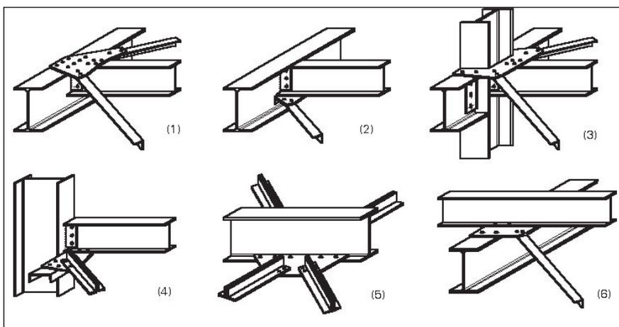
Gli elementi diagonali sono usualmente imbullonati ad una piastra nodale opportunamente sagomata. Nel caso di controventi di piano, la piastra nodale, se non vi sono interferenze costruttive con il solaio sovrastante, viene realizzata in corrispondenza dell'ala superiore della trave (1) altrimenti va posizionata sull'anima (2) o sull'ala inferiore della trave stessa (4-5).
