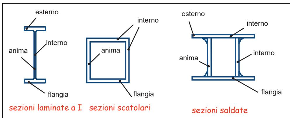
Quando alcuni elementi componenti sono **relativamente sottili possono instabilizzare localmente, limitando la capacità portante e la resistenza flessionale del profilato. Per evitare tale fenomeno** è necessario impiegare profilati le cui parti elementari siano caratterizzate da un **rappporto  $b/t$  (larghezza/spessore) sufficientemente basso**.
