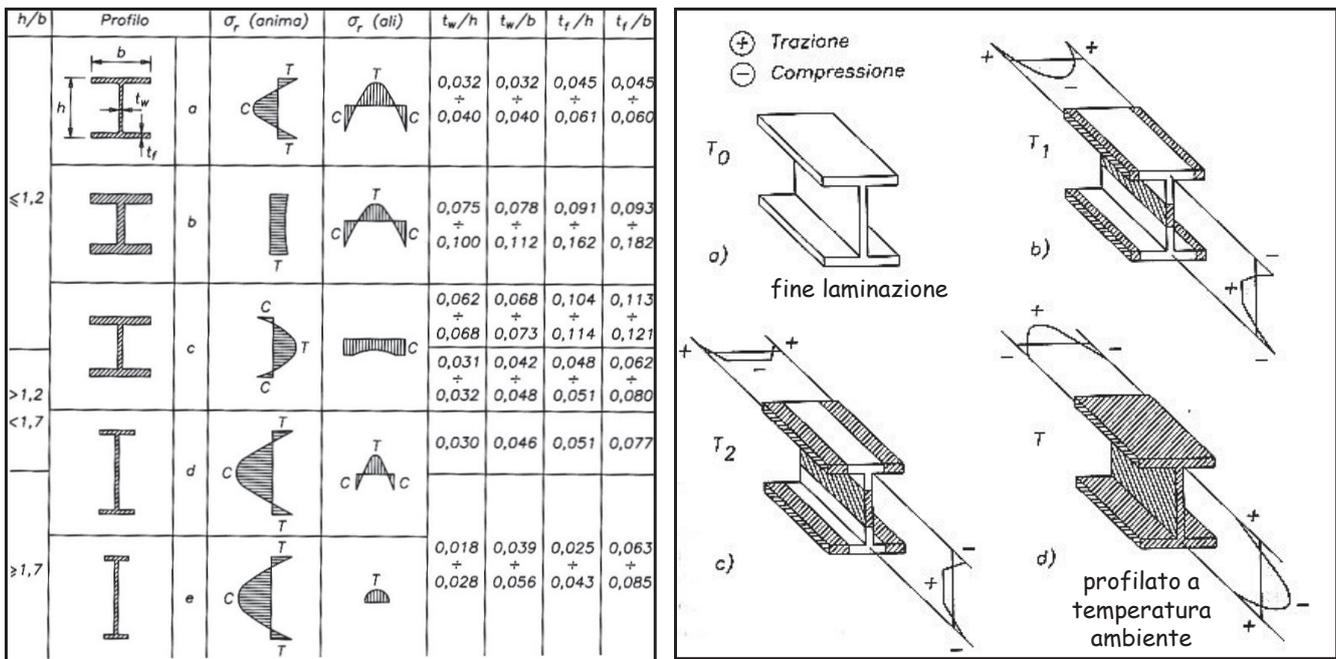
Per tutti i tipi di prodotti, l'andamento e l'entità delle tensioni residue dipendono dalle caratteristiche geometriche della sezione e in particolare dal rapporto larghezza/spessore delle sue componenti ali/anima.
