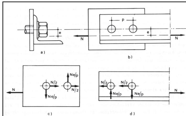
Se gli assi baricentrici delle aste di ciascun nodo convergono in un punto, la piastra di collegamento e le aste sono sollecitate da solo sforzo assiale  $N$  mentre il collegamento bullonato è sollecitato oltre che da  $N$  anche da un **momento parassita** proporzionale alla distanza tra l'asse di truschino e l'asse baricentrico dell'asta.
