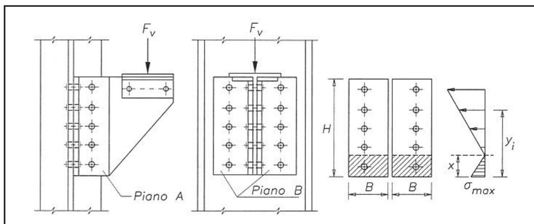
Per la verifica della bullonatura nel piano B del collegamento in figura la sollecitazione di taglio e flessione può essere condotta in campo elastico, ipotizzando la planarità della sezione ed assumendo una distribuzione lineare delle deformazioni (analogamente a quanto avviene per le sezioni inflesse in c.a.).
