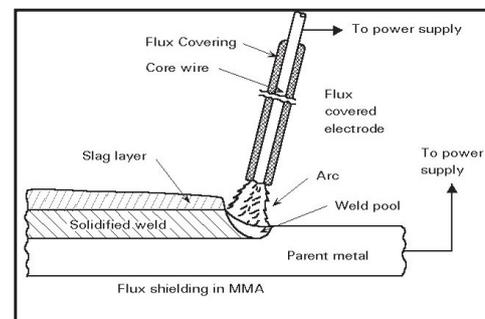
L'elettrodo è formato da un metallo analogo a quello da saldare ed è rivestito da un materiale le cui funzioni sono quelle di formare una atmosfera gassosa che protegge l'arco elettrico e dare luogo a una scoria più leggera del metallo che galleggia nel bagno di fusione che solidificandosi protegge il bagno fuso e limita la velocità di raffreddamento del bagno stesso prevenendo la formazioni di difetti. Gli elettrodi impiegati dovranno essere del tipo omologato dalle norme UNI 5132.
