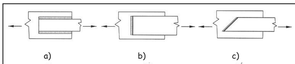
Ai fini delle verifiche di resistenza le norme (CNR10011, D.M. 2018) fanno riferimento a due categorie di unioni saldate:
