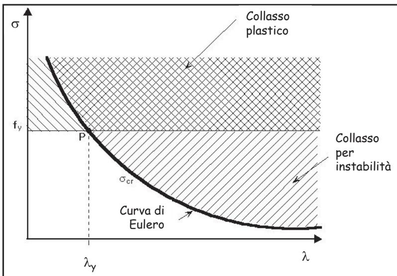
Se si tiene conto solo della limitata resistenza del materiale  $f_y$  e si trascura l'influenza delle imperfezioni meccaniche e geometriche: il dominio di resistenza di un'asta compressa nel piano  $\sigma$ - $\lambda$  è dato dall'intersezione tra l'iperbole di Eulero (che individua il collasso per instabilità) e la retta  $\sigma=f_y$  (collasso plastico). Quando il punto rappresentativo dello stato tensionale dell'elemento sta all'interno di tale dominio non si ha collasso.
