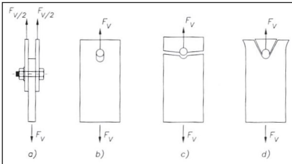
La resistenza di progetto dell'unione è associata al meccanismo di rottura più debole.
