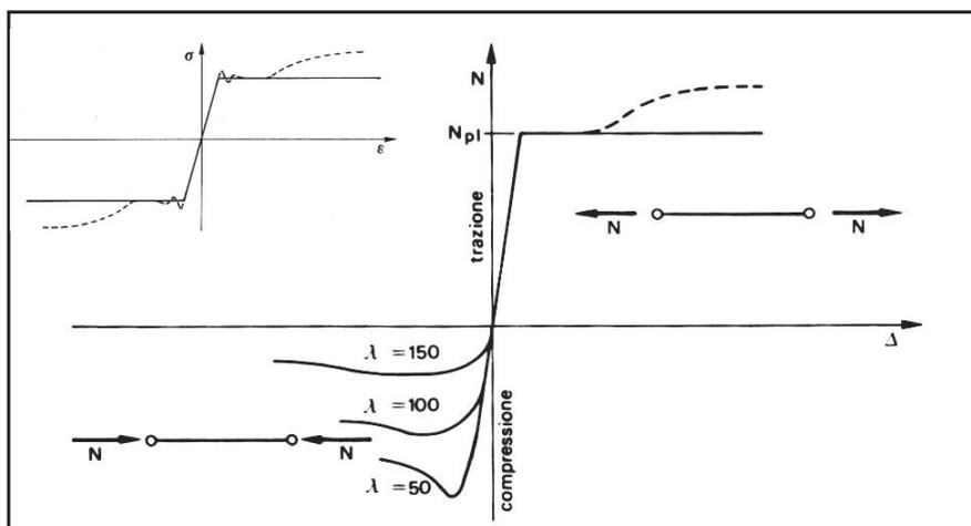
Un'asta soggetta ad azione assiale  $N$  costituisce un elemento strutturale con legame costitutivo  $N(\Delta)$  non simmetrico. A trazione può considerarsi con buona approssimazione di tipo elastoplastico, mentre a compressione il legame è curvilineo e il suo limite massimo dipende dalla snellezza e dalle imperfezioni geometriche e strutturali dell'asta.
