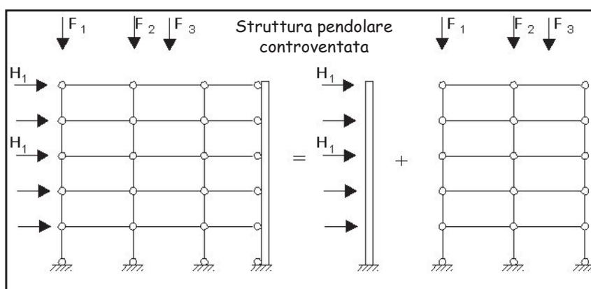
La struttura risulta isostatica:
