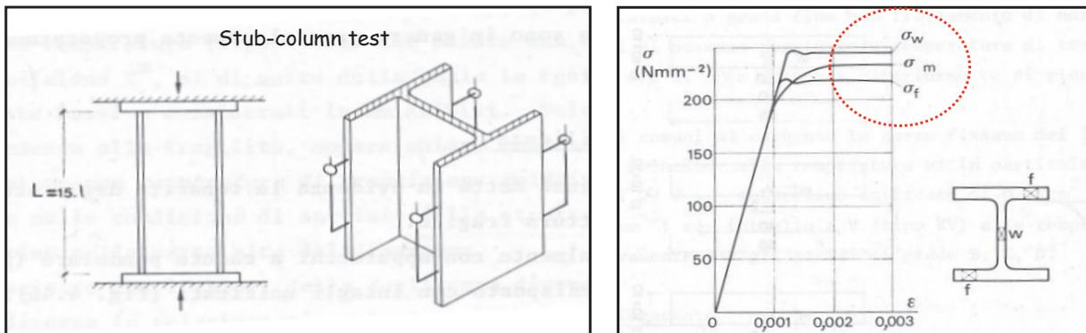
Il diagramma  $\sigma$ - $\epsilon$  ottenuto dalla prova di compressione globale (stub-column test) presenta in genere una tensione limite di proporzionalità più bassa rispetto a quella corrispondente alla prova di trazione su singoli provini. Ciò è dovuto alla presenza di imperfezioni strutturali che rivestono un ruolo degradante sulla resistenza dei profilati.
