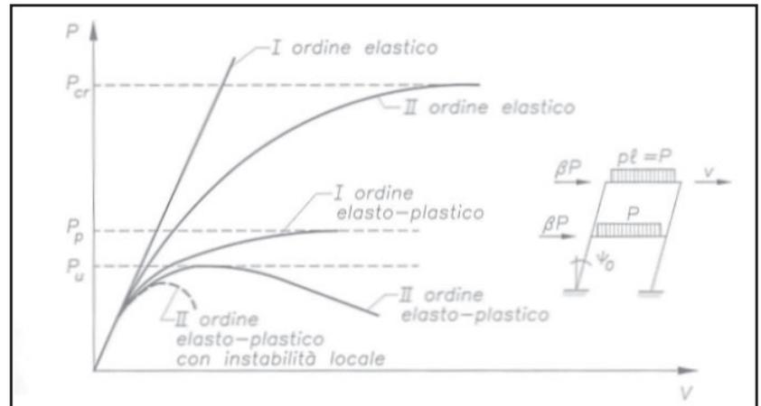
Nel caso di strutture controventate esiste una ripartizione dei compiti tra elementi strutturali che riprendono i carichi verticali e sistemi strutturali a cui è affidato il compito di resistere alle azioni orizzontali. Le travi orizzontali risultano inflesse nel piano verticale (sotto l'azione dei carichi verticali), le colonne semplicemente compresse e le giunzioni a cerniera fra travi e colonne devono assorbire solo le azioni taglianti.
