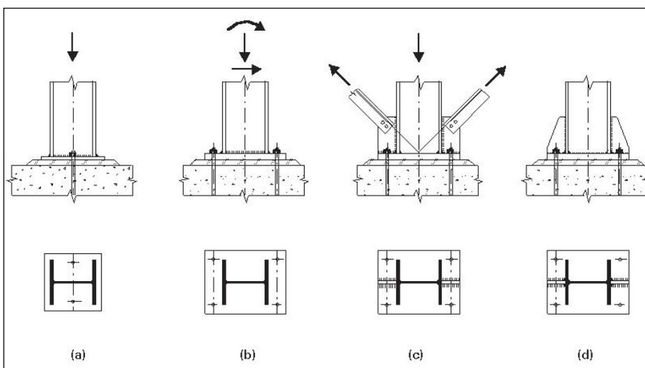
Se la colonna risulta **semplicemente compressa**, la trasmissione della forza di compressione alla fondazione avviene per contatto con la piastra di base.
