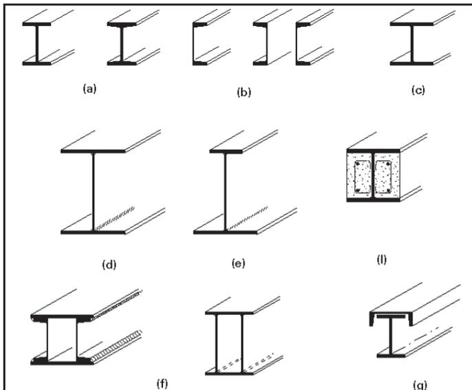
Si ottengono notevoli vantaggi solidarizzando i solai alle travi mediante connettori da annegare nel calcestruzzo realizzando **strutture miste acciaio calcestruzzo**.
