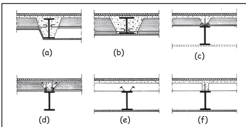
I tipi a,b,c,d sono derivati dalla tecnologia del c.a. e richiedono generalmente l'esecuzione di banchinaggi intermedi e di collegamento tra le armature dei travetti e le travi di acciaio. Per tale motivo si utilizzano più frequentemente, negli edifici in acciaio, solai con lamiera grecata.
