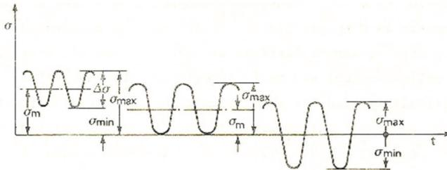
Per scongiurare la rottura a fatica bisogna evitare la concentrazione di tensioni e bruschi cambiamenti di sezione in zona soggette a trazione.
