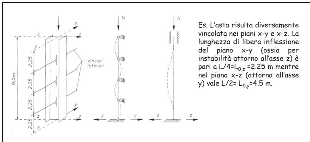
Determinazione delle lunghezze libere di inflessione in funzione dello schema statico.
