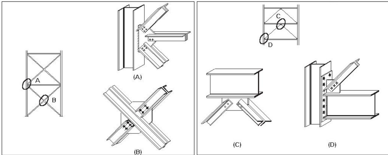
Si nota che bisogna porre particolare attenzione alle fasi di trasporto di colonne o travi con fazzoletti o piatti di nodo collegati in aggetto in stabilimento.
