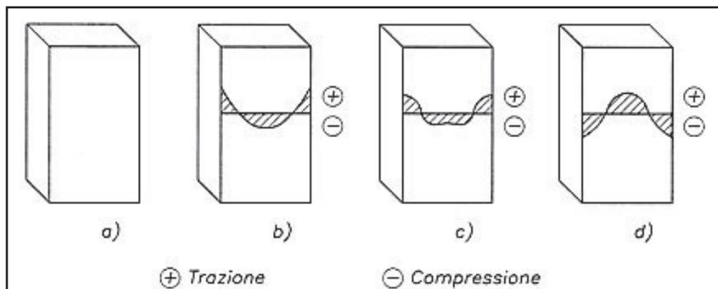
Andamento nel tempo delle autotensioni dovute ad un raffreddamento differenziale della sezione.
