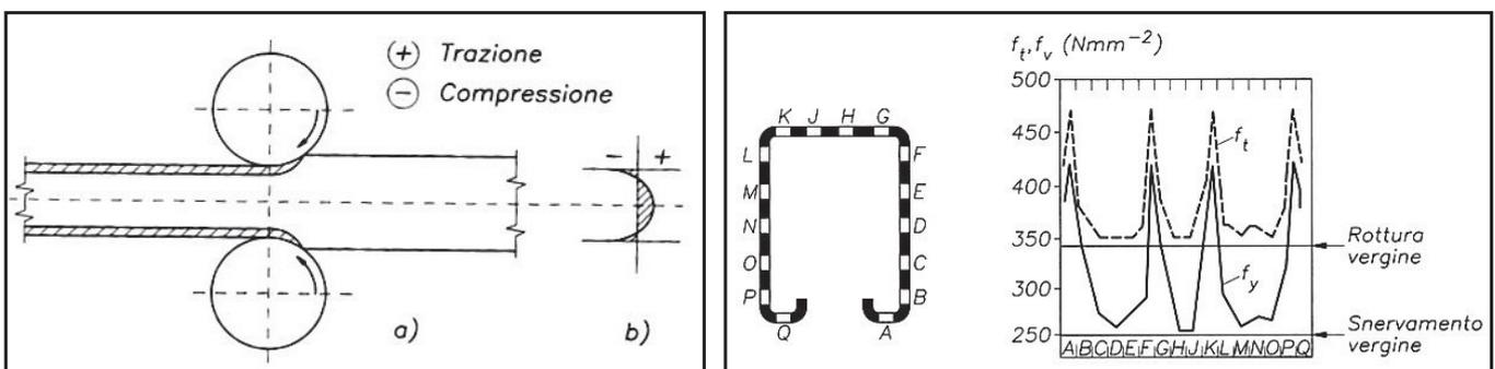
I profilati sagomati a freddo possono presentare ulteriori tipi di imperfezioni meccaniche: a seguito della lavorazione mediante piegatura o stampaggio vengono alterate le caratteristiche meccaniche in prossimità delle zone di piega. In queste si ha una deformazione plastica che corrisponde alla deformazione permanente necessaria per conferire la forma voluta.
