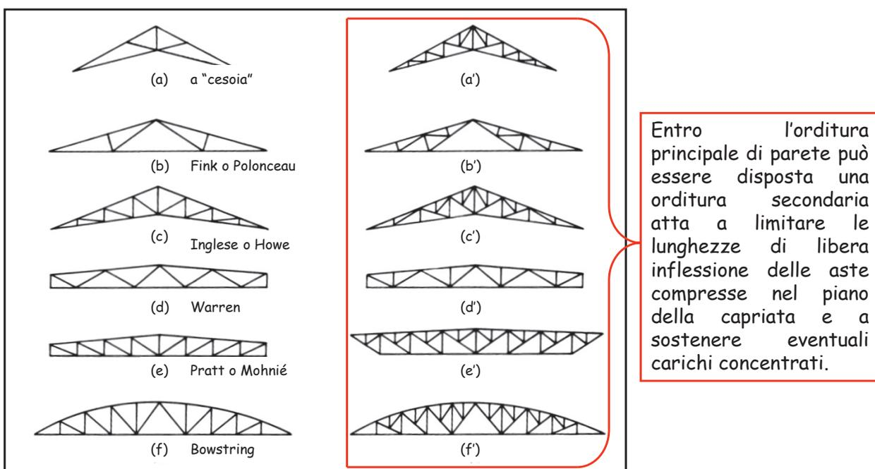
Nella valutazione della capacità portante degli elementi compressi delle travi reticolari principali è necessario **calcolare la lunghezza di libera inflessione sia nel piano verticale (piano della trave reticolare) che nel piano orizzontale**. Nel primo caso la lunghezza di libera inflessione  $L_{c,v}$  può essere assunta pari alla distanza fra i nodi, mentre nel secondo caso dipende dall'orditura tridimensionale della copertura.
